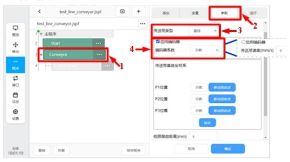
接下来需要对传送带基座坐标系进行示教,在参数界面,在机器人基坐标系下,依次示教P1点的位置(1处),P2点的位置(2处),P3点的位置(3处),最后点击标定按钮(4处)。标定成功的话,系统会根据示教点位计算出传送带基座坐标系并显示(5处),最后通过点击添加到系统(6处)并输入传送带基座坐标系名称 ConvBase,用户可根据自己使用习惯进行修改,将传送带基座坐标系 ConvBase 添加到系统中,本例中以 ConvBase 进行说明。从而完成传送带基座坐标系的标定,后续章节中会详细介绍 P1、P2、P3的点位选取。
