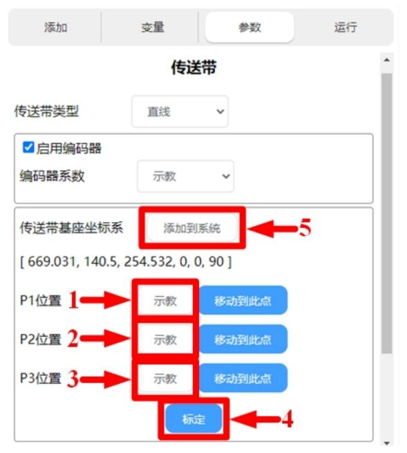
对于直线传送带: P1、P2、P3点的选取,需要注意的是,P1点位置是传送带基座坐标系的位置,即工件刚好触发光电开关信号,工件上标记点在机器人基坐标系下的位置。若使用视觉系统,则参考相应视觉应用说明配置视觉系统,编写程序由视觉系统获取触发时刻工件相对于传送带基坐标系的校准值 calibration,保证视觉系统获取的工件坐标系相对于传送带基坐标系的校准值比较准确,且机器人控制器能够及时获取视觉系统的计算校准值。P2点则是工件跟随传送带运动一段距离后的,工件上标记点在机器人基坐标系下的位置,在机器人及传送带工作范围内,尽量使传送带运动距离大一点,这样有利于标定结果的准确。P3点则是在工件标记点与传送带平行平面内,任意选择的点。直线传送带基座坐标系标定示意图如下:
