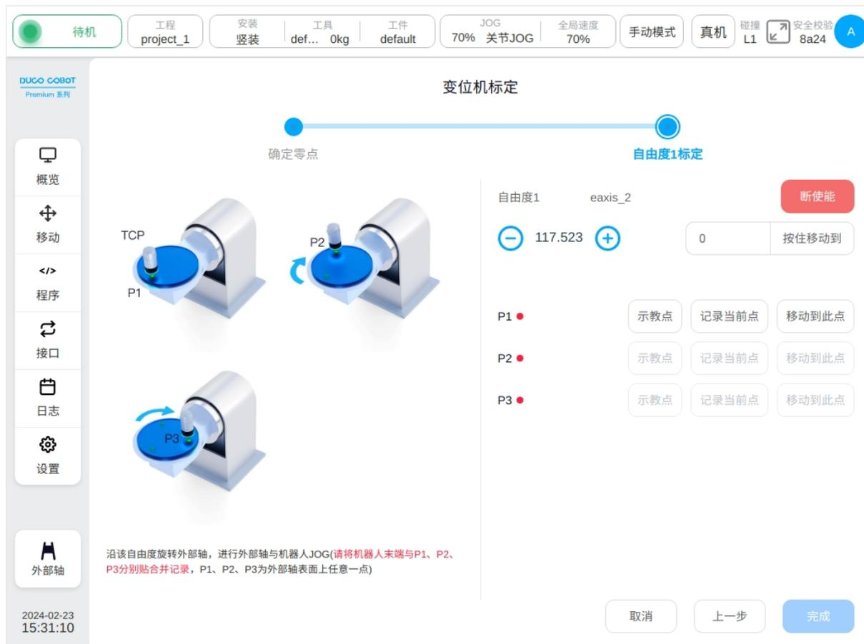
2、自由度1标定：P1、P2、P3分别为外部轴表面上任意一点，JOG外部轴与机器人，使机器人末端与P1、P2、P3点分别贴合并记录；示教并记录好机器人末端位置点位后，点击“完成”即可。
