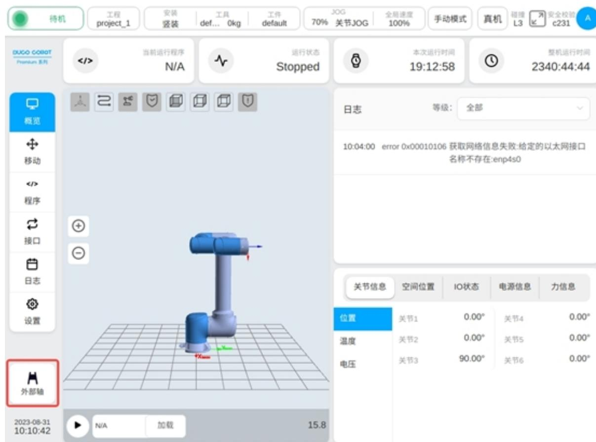
9、外部轴工艺包安装完成后，将在主页面的左下方，出现工艺包配置入口。
