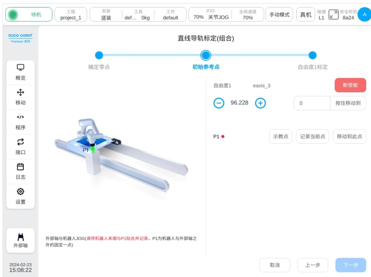
2、初始参考点：P1 点为机器人与外部轴之外的固定一点，分别 JOG 外部轴与机器人，使机器人末端与 P1 点贴合并记录；示教好机器人或外部轴位置后，P1 点后由
