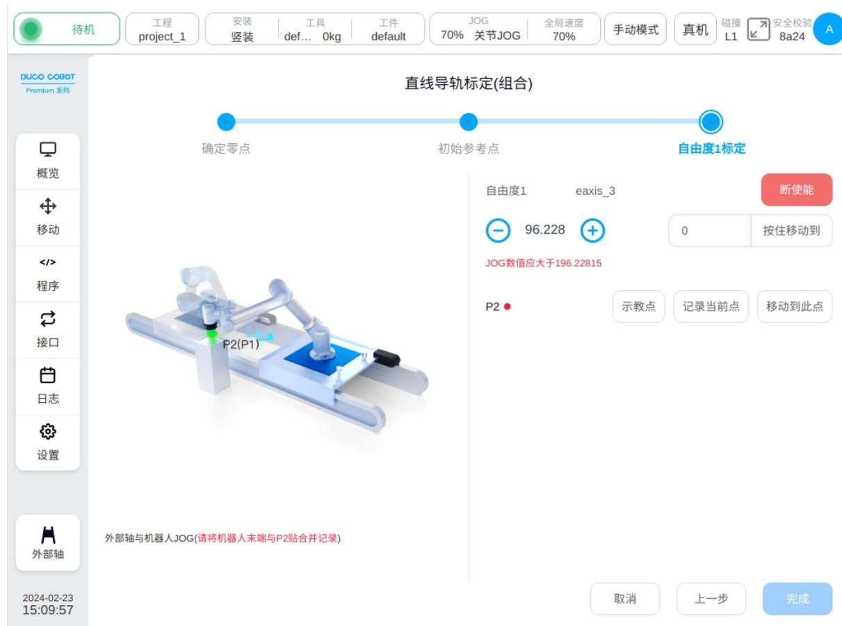
3、自由度 1 标定：同样地 JOG 外部轴与机器人，使机器人末端与 P2 点（物理环境中即为原 P1 点）贴合并记录；示教并记录好机器人末端位置点位后，点击“完成”。
