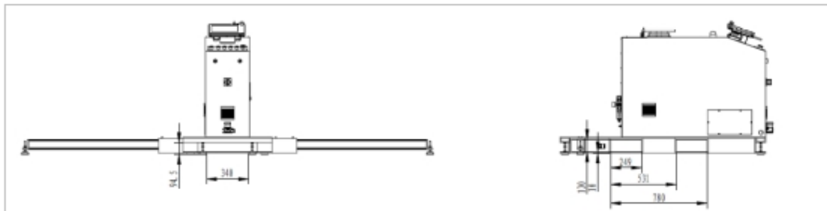
图 4.15 插槽和底座的对齐方式和对应的尺寸
