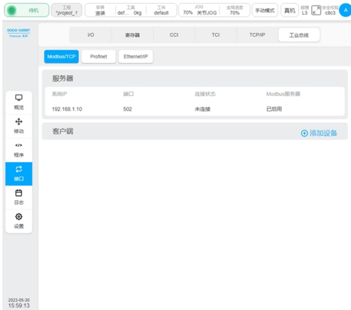
界面上方显示 Modbus 服务器系统 IP、端口、连接状态等信息。单击“添加设备”，会弹出虚拟普通键盘，输入外部 Modbus 客户端设备的 IP 地址，如输入：192.168.218.163，界面会显示该 Modbus 设备 IP 地址及相关操作图标。
