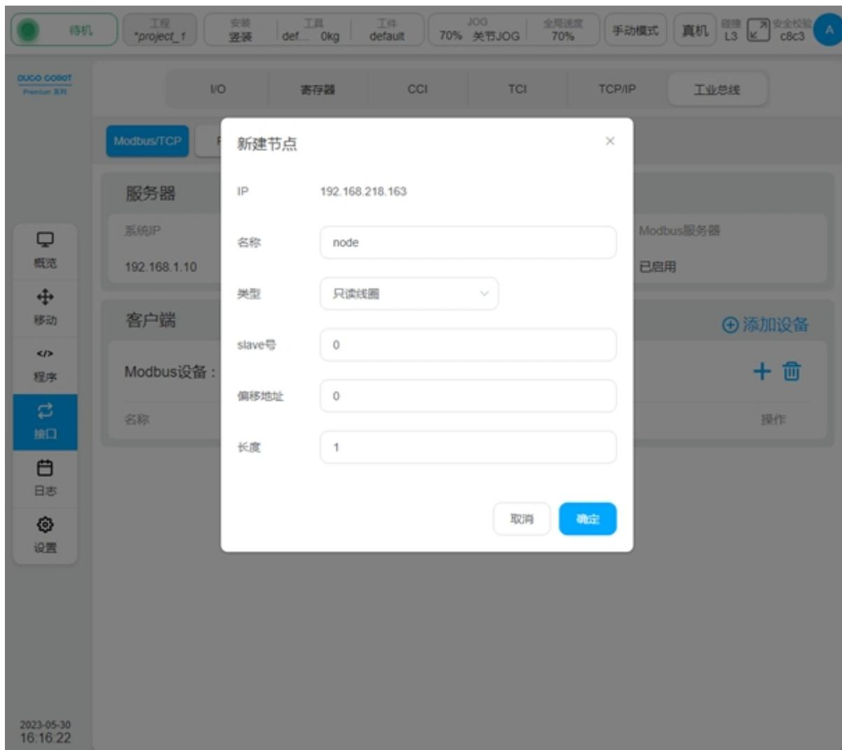
新建节点时，长度值默认为 1。当长度值为 1 时，创建单个节点；当长度值大于 1 时，会批量创建出多个节点。假如长度设置为 3，根据设置长度节点名称后依次加下划线后缀，即：node\_1、node\_2、node\_3，地址依次为 0、1、2，如图所示。
