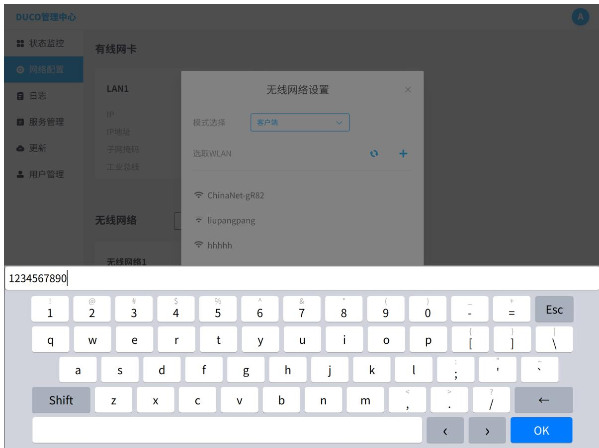
外部设备通过显示的 IP 地址（以实际显示为准）192.168.24.243:7000 登录机器人，通过 192.168.24.243:7200 登录管理中心
