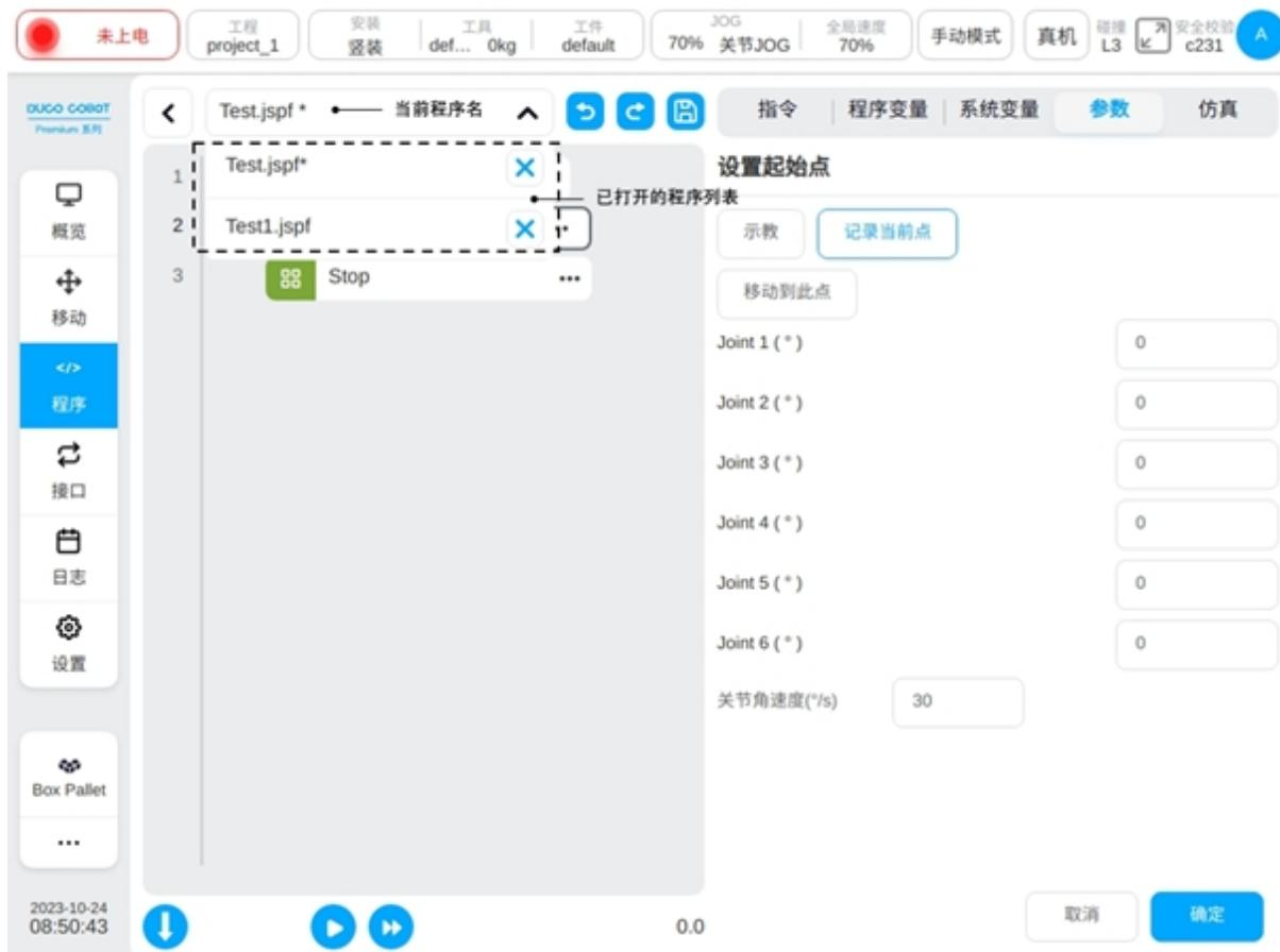
如上图所示，已打开的程序列表显示了当前系统中有两个打开的程序，点击下拉框里名称右侧的 按钮可以关闭该程序；点击下拉框列表项栏可切换至对应程序。
