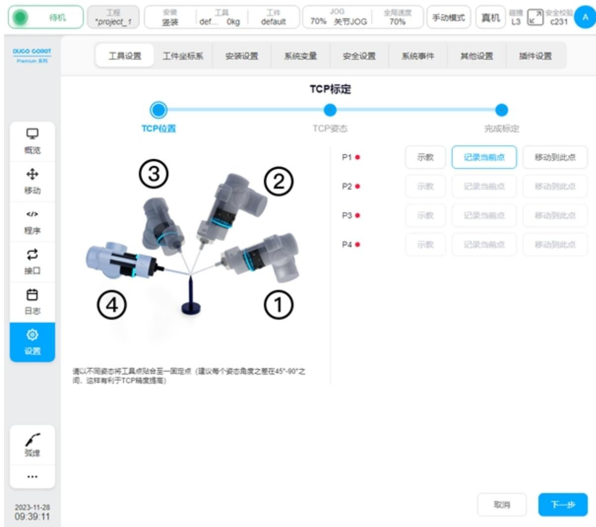
首先，需要以不同姿态将工具点贴合至标定针固定点，即示教好 P1-P4 点，且建议点与点之间的姿态角度变化在 45° 至 90° 之间，这样有利于提高 TCP 标定精度。以 P1 点为例，单击 P1 点处的“示教”按钮，界面会跳转到移动页面，移动机器人到目标点后，单击“记录当前位置”，界面会跳回当前示教标定点界面，且示教好一个标定点后，对应标定点后的红色圆点会变成绿色。也可通过示教器物理按钮直接移动机器人到目标点位后，直接单击“记录当前点”。示教过程中，如果当前示教点位不满足限制条件会弹框提示如下：
