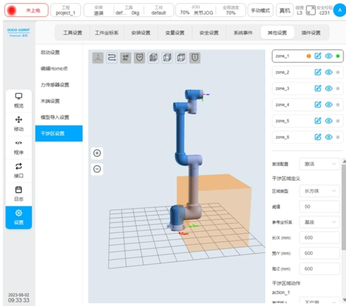
当配置区域类型为圆柱体时，其设置基准时基于世界坐标系/基座/自定义的工件坐标系。以工件坐标系作为圆柱体底面的圆心，Z方向指向高度方向，可以设置半径、高度。半径取值范围为0-3000mm，高度取值范围为-3000mm—3000mm。
