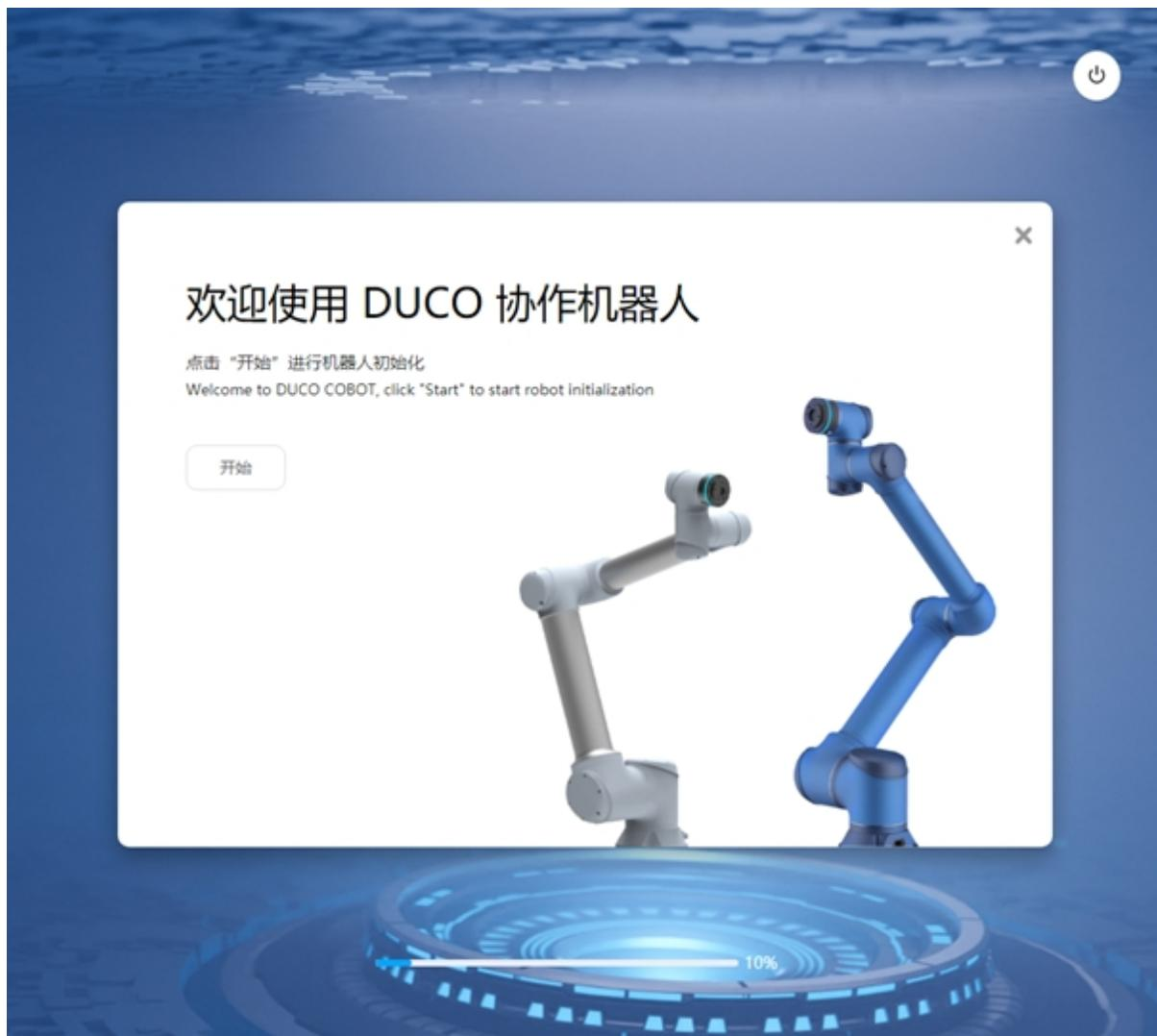
2. 点击“开始”按钮，进行机器人初始化。显示“正在初始化…”进度条，初始化完成显示“初始化完成”。
