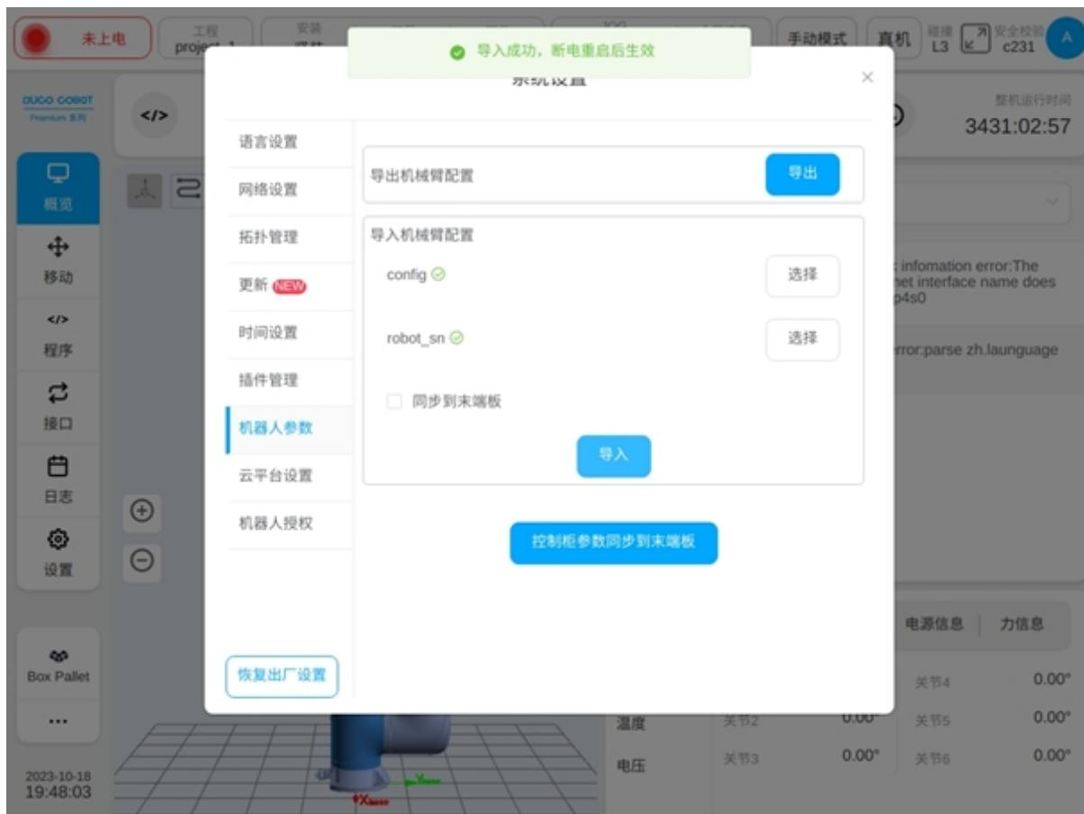
点击“控制柜参数同步到末端板”按钮，可以将控制柜内的机器人参数，同步到机器人的末端板中。
