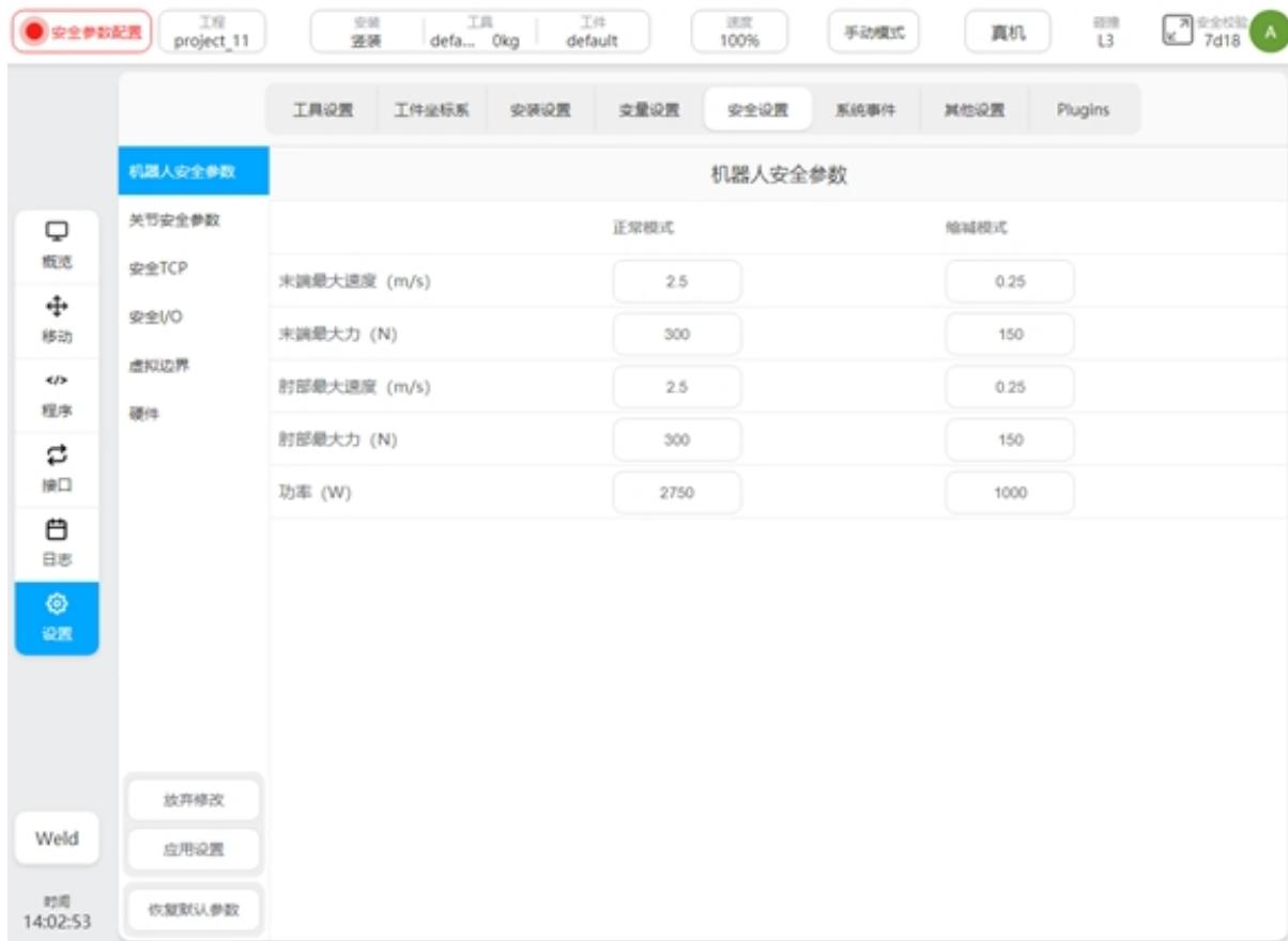
更改配置时，本次的修改内容将标记为高亮黄色显示出来。所做的所有更改只有在点击“应用设置”按钮时才会生效。点击“恢复默认设置”，将会将所有的安全参数恢复到默认的出厂设置值。点击“应用设置”按钮后，会弹出提示框，如图所示。
