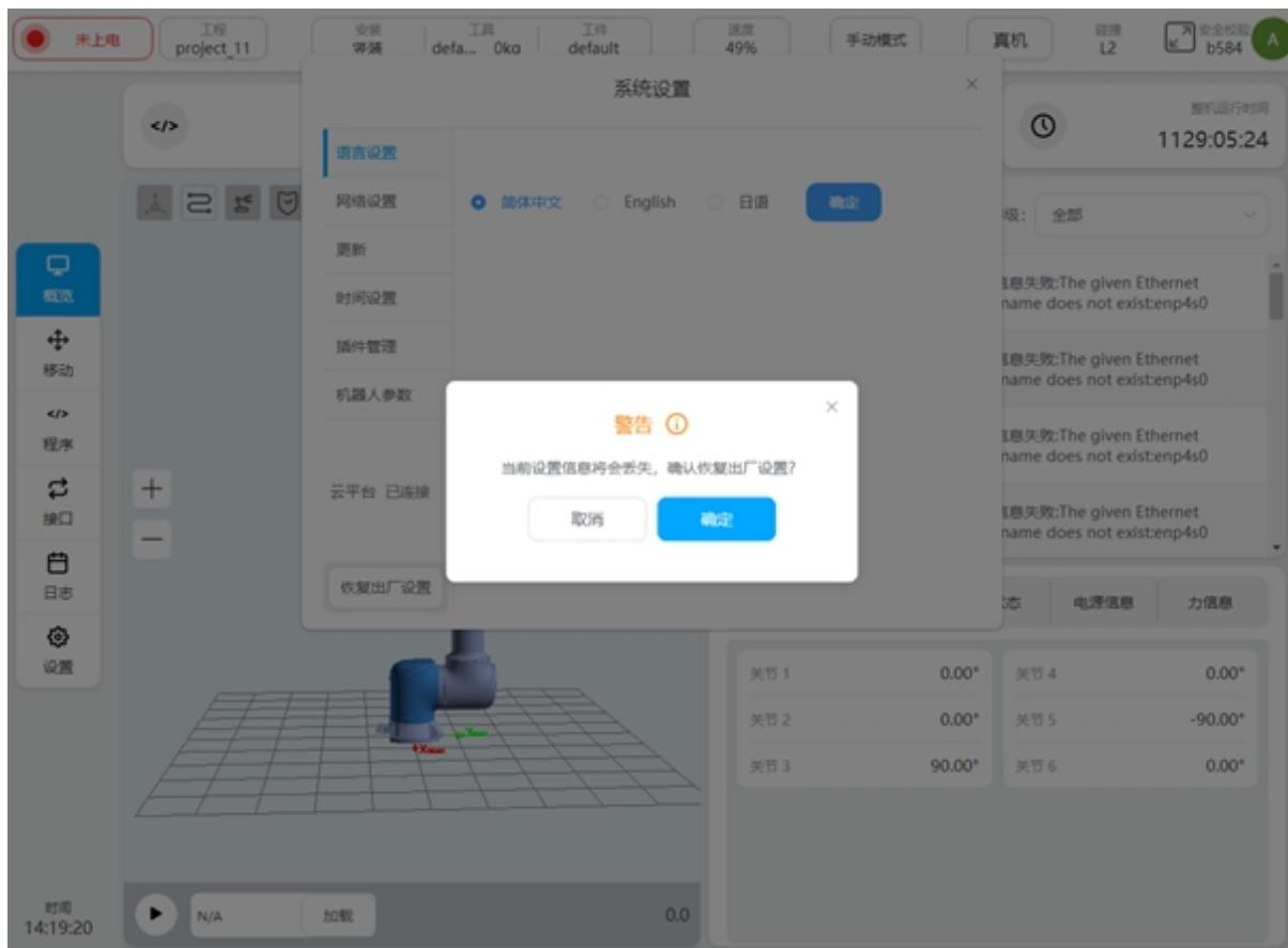
单击“取消”按钮，即取消恢复出厂设置；单击“确定”按钮后，界面上方会显示“恢复出厂设置成功，需重启生效！”弹框。恢复出厂设置后，会清空如下内容：project 中所有非 template 工程、所有 logs 日志、robot\_sn 文件以及系统文件下的 project 和默认的 IP 地址。
