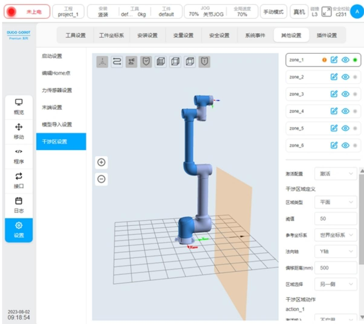
当配置区域类型为平面时，平面区域的参考基准是基于世界坐标系/基座/自定义的工件坐标系，通过设定平面法向轴、法向偏移距离从而确定平面。平面的设置可以通过“区域选择”配置生效区域，且对应方向在3D区域中通过黑色箭头显示。
