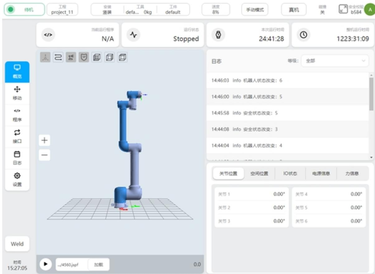
移动界面允许用户手动操作机器人，设置手动移动的坐标系及运动方式。
