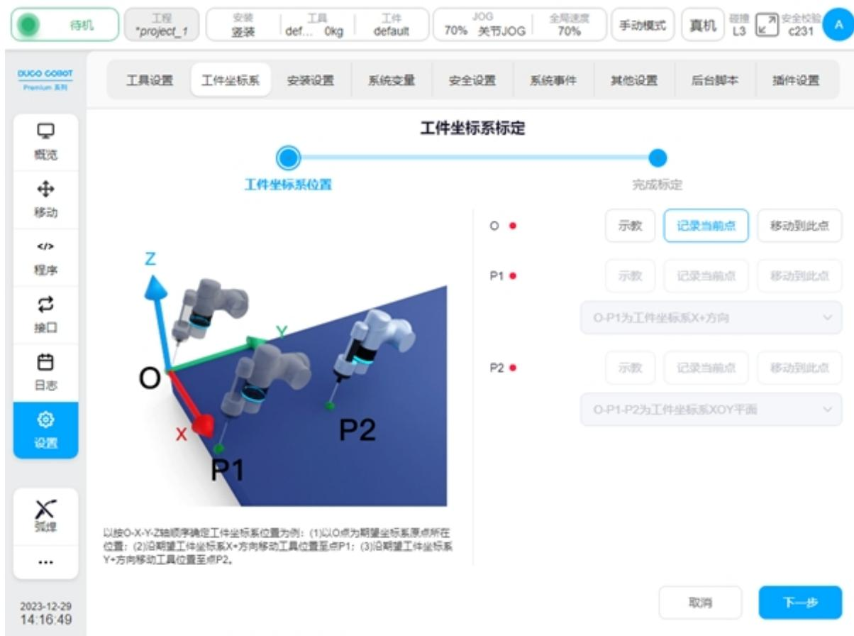
设置 O 点为工件坐标系的原点，P1 点可选项有 O-P1 为工具坐标系 X+ 方向 / Y+ 方向 / Z+ 方向，P2 点对应可选项有 O-P1-P2 为工具坐标系 XOY 平面/XOZ 平面、O-P1-P2 为工具坐标系 XOY 平面/YOZ 平面、O-P1-P2 为工具坐标系 XOZ 平面/YOZ 平面。以按 O-X-Y-Z 轴顺序确定工具坐标系姿态为例：点 O 为当前工具位置所在位置，首先沿期望工件坐标系 X+ 方向移动工具位置至点 P1，接着沿期望工件坐标系 Y+ 方向移动工具位置至点 P2。
