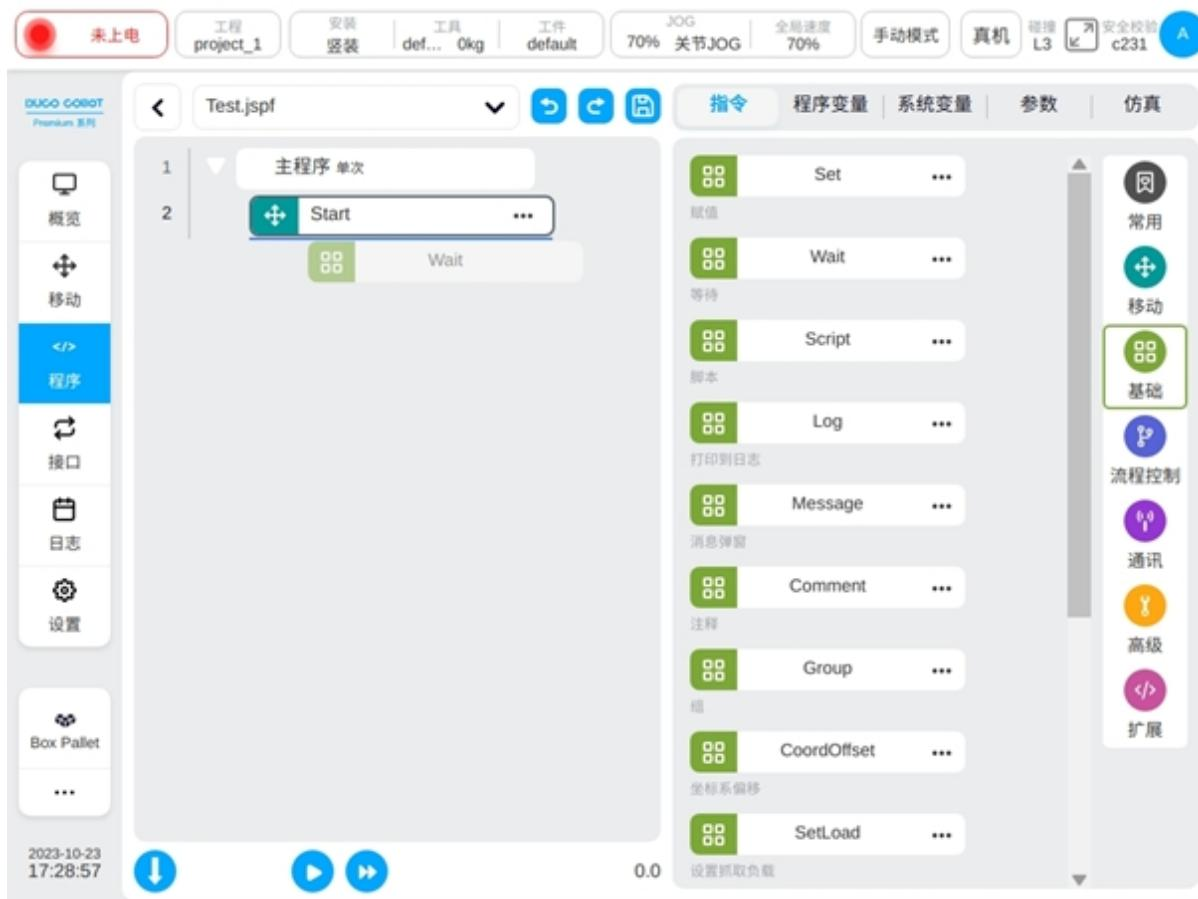
程序树中的功能块有以下五种状态，红色代表该功能块未配置有效的参数；斜体加 \* 代表该功能块的参数发生改动，但是未保存到程序树中；黑色正体代表该功能块是参数有效、无改动；功能块部分灰显代表已选中可进行拖拽的状态；功能块全部灰显代表该功能块设置为不启用。
