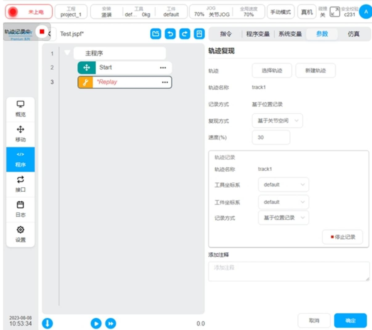
对于选取的轨迹，当复现方式为基于关节空间时，会显示该轨迹的轨迹名称、记录方式；当复现方式为基于笛卡尔空间时，会显示该轨迹的轨迹名称、记录方式以及记录时刻的工具坐标系和工件坐标系。
