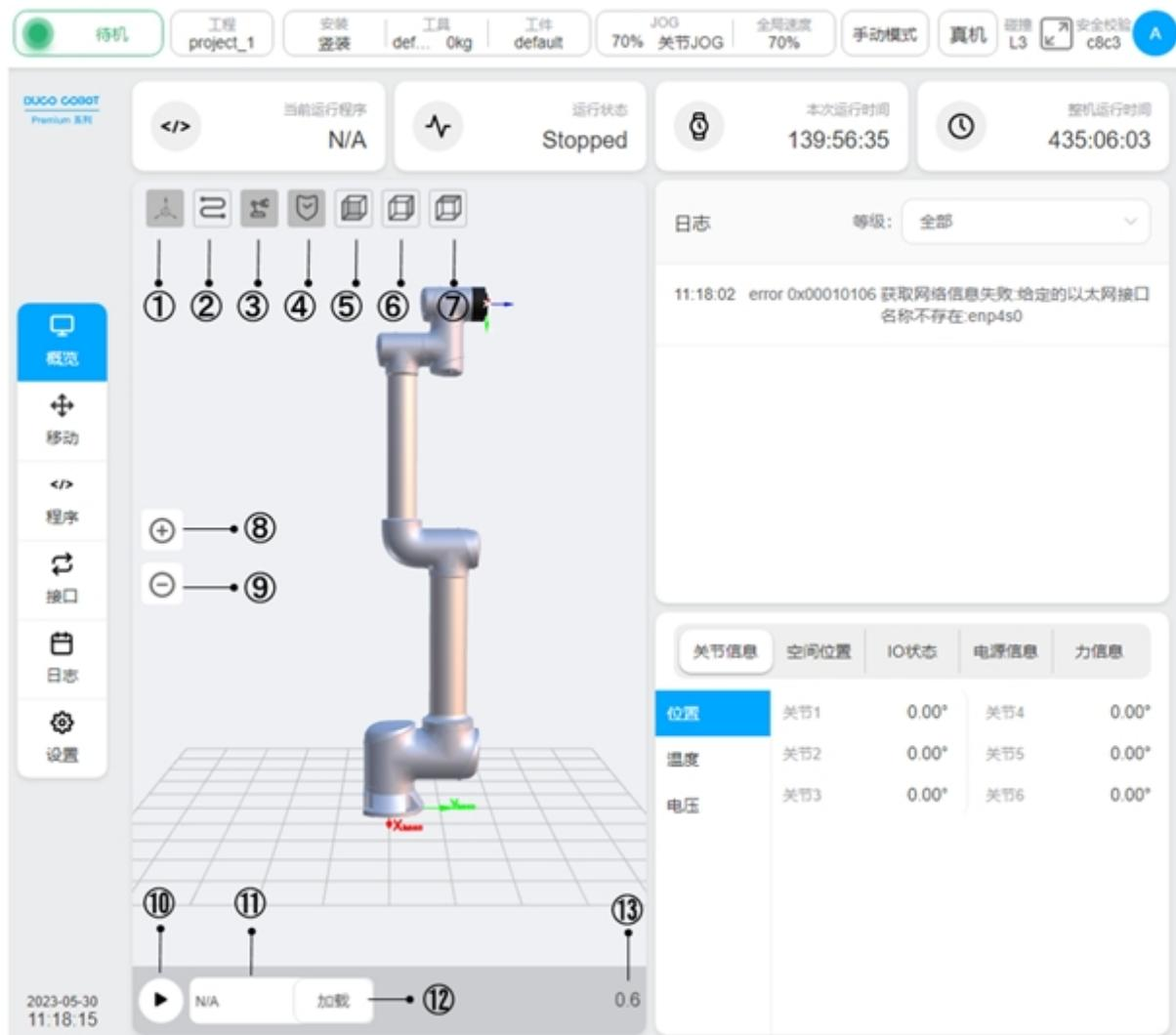
单击“加载”按钮，会弹出程序列表界面，如图所示。程序列表罗列出所有文件夹（如：Test\_1）和后缀名为.jspf的程序文件（如：ee.jspf）。界面下方有“返回上层”、“取消”、“选择”三个按钮。
