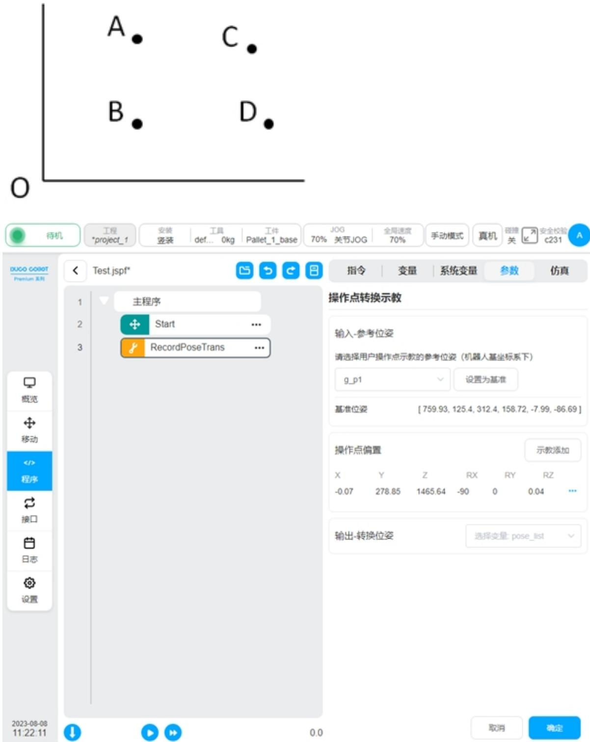
配置页如图，有三部分，“输入-参考位姿”中设置参考点位(O点)，“操作点偏置”中设置操作点位(A,B,C,D点)，“输出-转换位姿”中设置变量存放计算得到的操作点位，即储存A',B',C',D'位姿。配置阶段，功能块将记录操作点(A,B,C,D点)相对于基准(O点)的偏差；程序运行时，根据当前输入变量的值(O'点)加上偏差计算得到操作点(A',B',C',D'点)的位姿。
