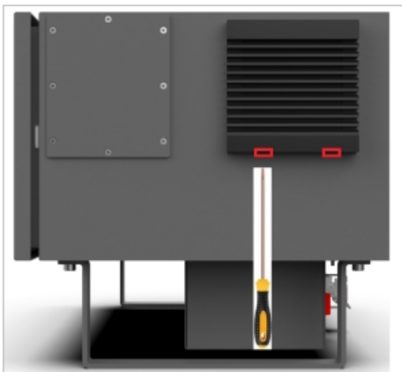
图 6-82 控制柜滤网清理
