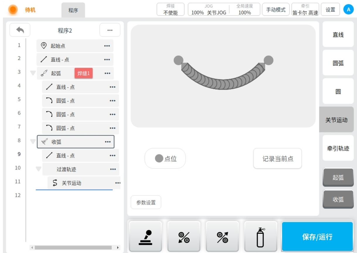
2. 点击起弧焊缝添加多层多道工艺，如果已在工艺库添加了多层多道工艺，则直接选择；如果使用专家系统则进入专家系统填写相关焊接参数生成；如果使用用户自定义工艺则进入用户自定义工艺添加工艺数据；
