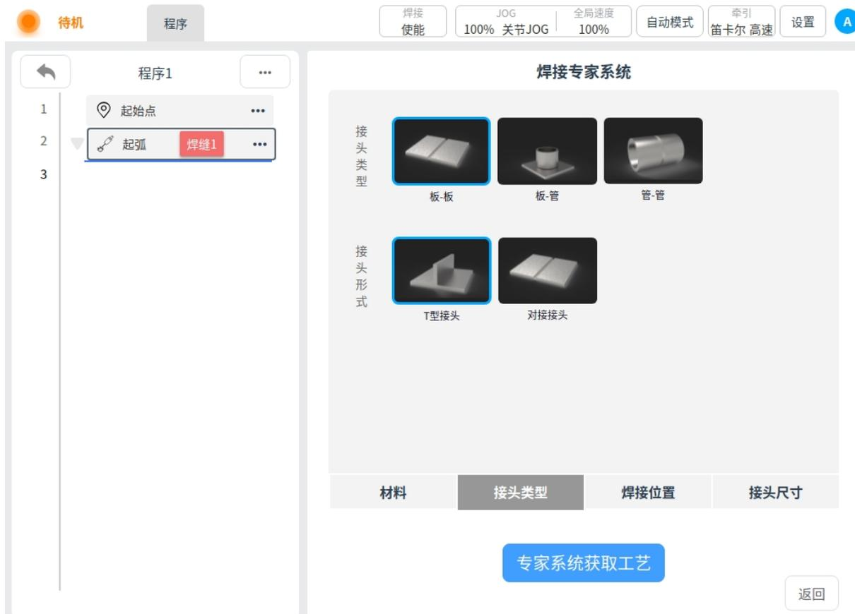
焊接位置中可配置参数有：平焊、横焊、立焊、仰焊。
