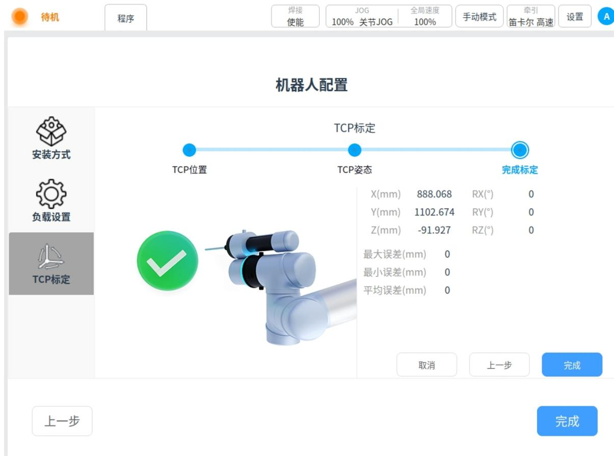
**Caution:** 定结果的误差值，真实含义是计算得到的 TCP 位置与 4 个标定点位之间距离的标准差。该数据可作为标定结果的参考，但不能作为标定精度的绝对依据，实际精度以应用效果为准。
