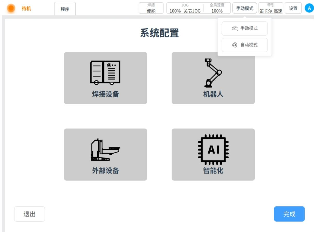
**牵引模式：**使用摇杆的情况下，显示当前激活的模式。包括关节牵引/笛卡尔牵引；高速牵引/低速牵引。用户可通过手柄上的按钮去切换使用的模式。
