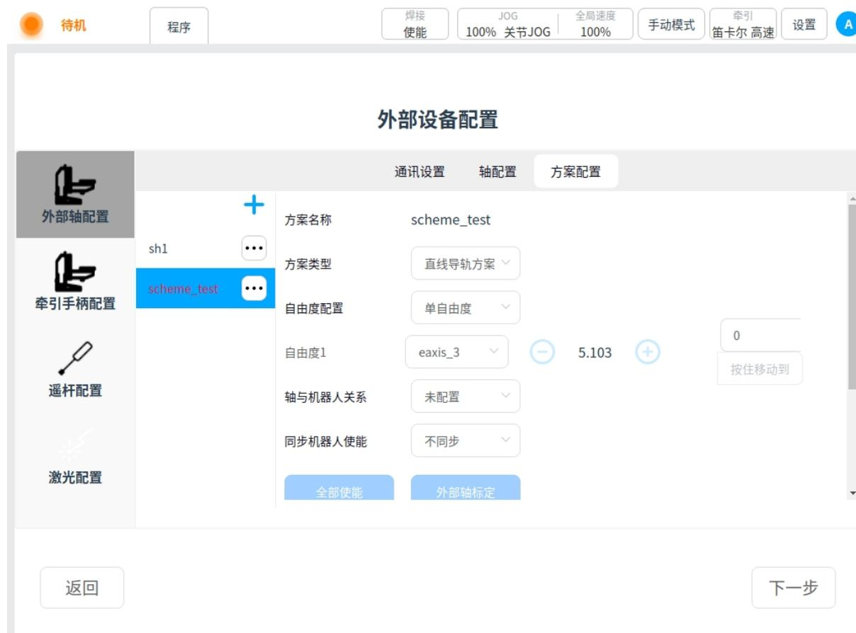
轴与机器人关系：独立或组合，即外部轴独立于机器人或机器人固定于外部轴上；
