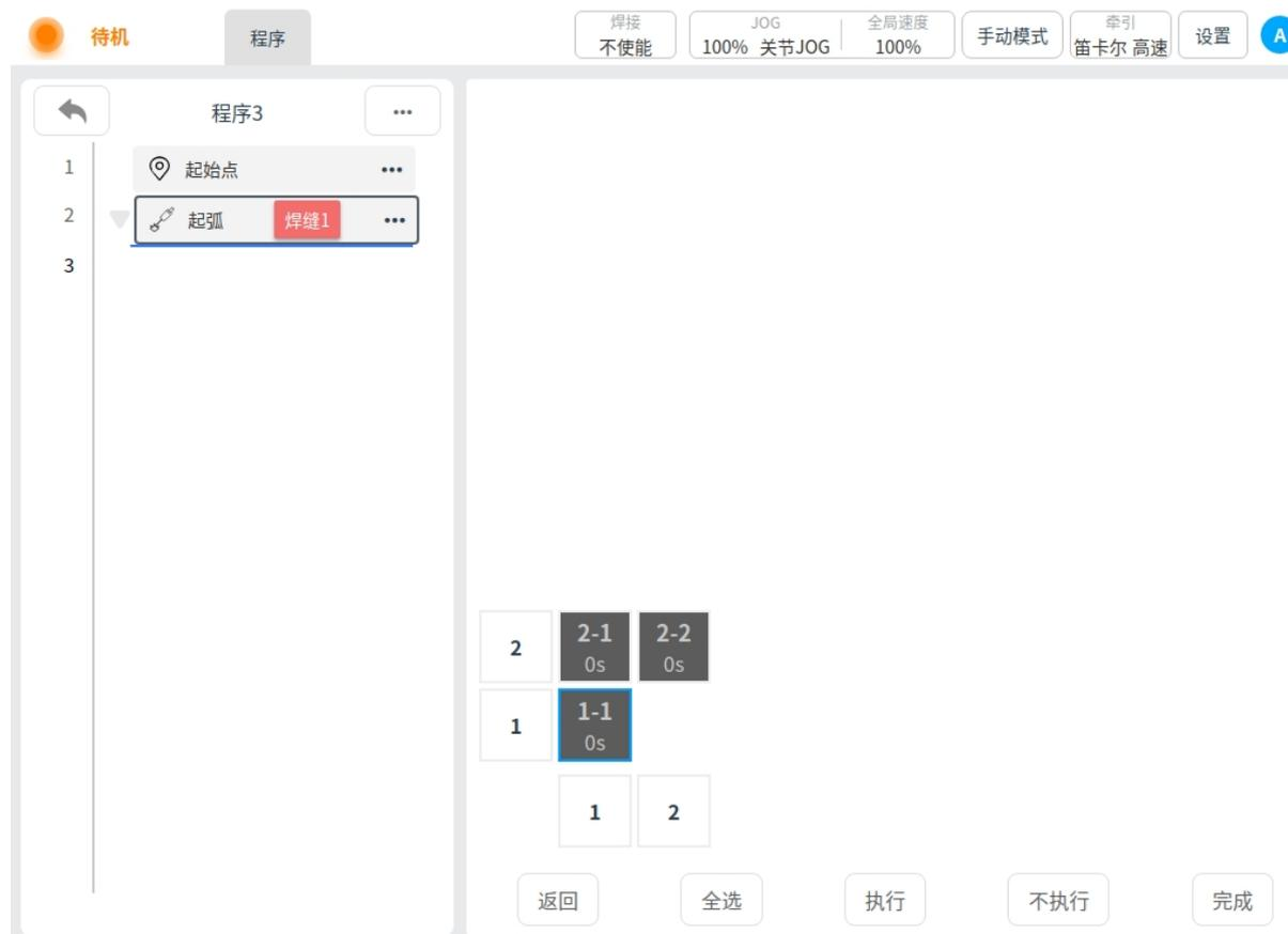
**功能：**进行多层多道的焊接，并可进行焊道延时设置和道间确认配置以及某一或多焊道任意执行操作；
