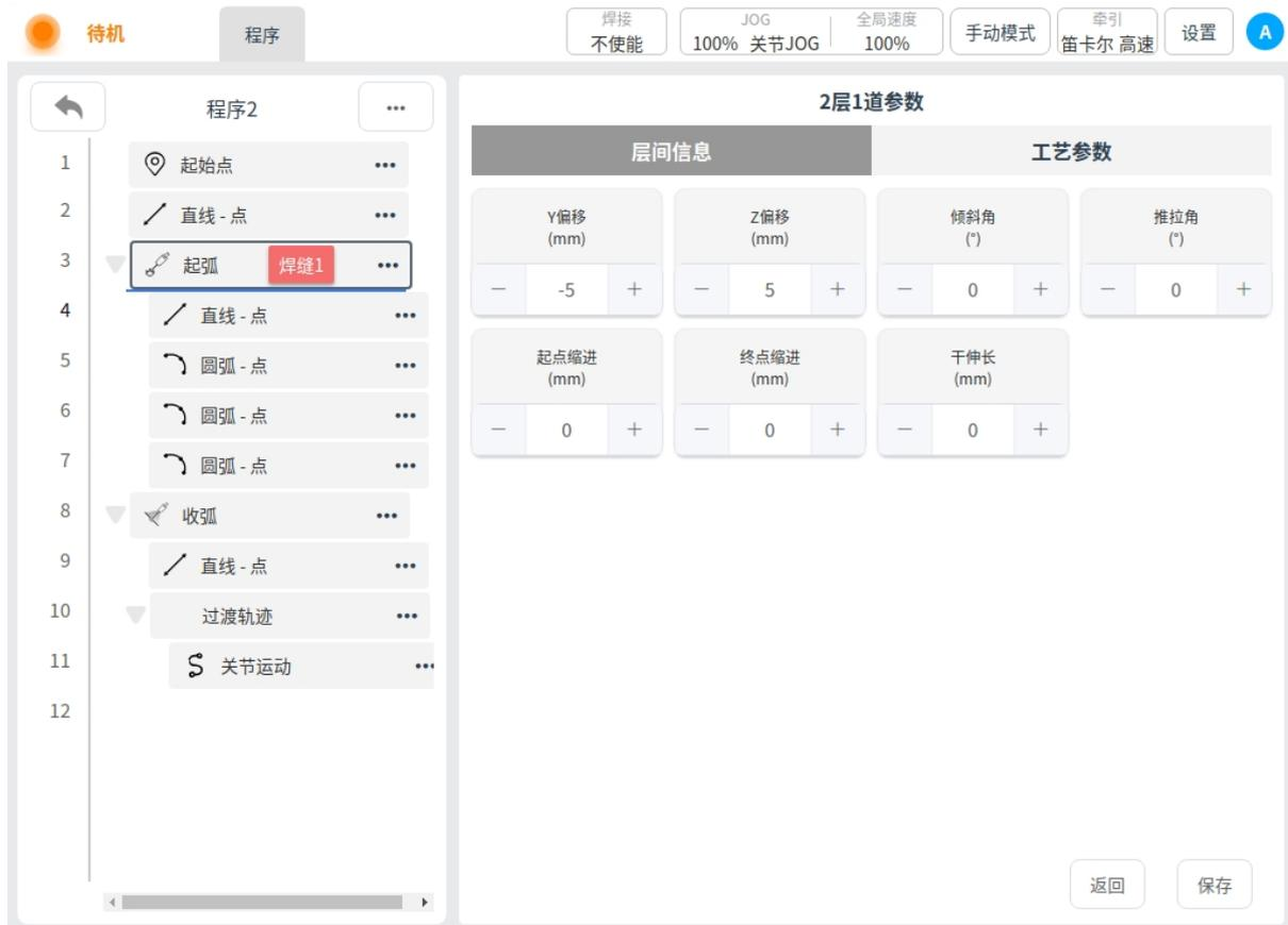
后续焊道配置同上，依次配置即可。配置完后点击返回按钮至下图页面，再点击焊缝设置；进入焊缝设置页面后，可根据需求开启相关功能（如电弧跟踪、焊接保护、多层多道等）。
