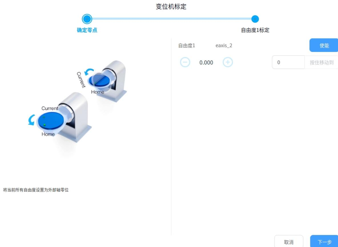
(1) 确定零点：可按住外部轴位置显示处左右两侧的图标，移动外部轴，确定外部轴零点位置，然后点击“下一步”按钮；
