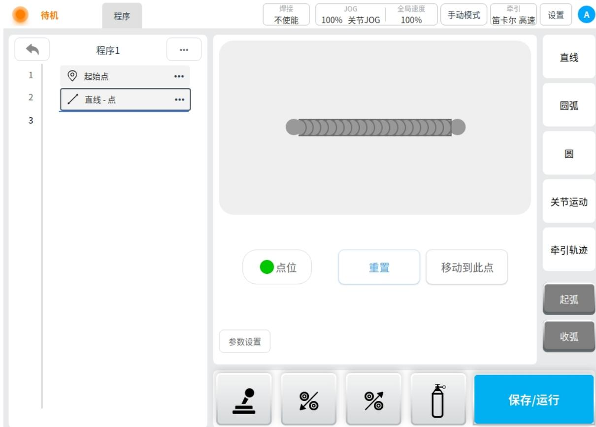
3. 点击页面右侧添加起弧指令按钮并进行焊接工艺设置，焊接工艺设置参考程序管理中 焊缝工艺与设置，焊道设置只需要设置单道；
