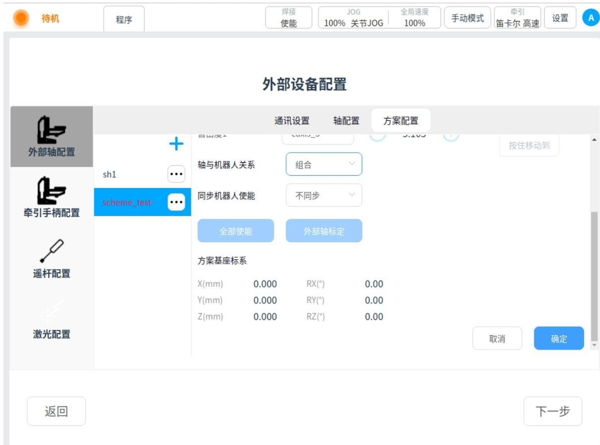
在外部轴方案编辑状态下，页面的“全部使能”或“全部断使能”以及“外部轴标定”按钮均被禁用，外部轴点动操作按钮也不可操作；只有在外部轴方案非编辑状态时，才可进行外部轴方案使能 / 断使能操作，以及外部轴标定，且外部轴点动按钮只有在外部轴方案使能状态下才可以操作，即所有外部轴使能状态下才可以进行点动操作。
