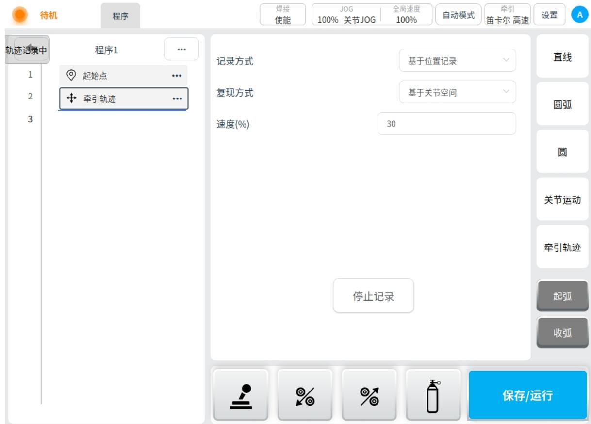
**起弧：**起弧非运动节点，其为‘指令’和‘焊缝’节点。在作为起弧指令节点同时，关联其焊接的焊缝相关配置；点击右侧起弧按钮，即可在指令区域中添加起弧节点，点击起弧节点后可在内容区域中配置焊缝相关的工艺和焊缝设置；焊缝工艺和焊缝设置后续单独说明；起弧后节点为当前起弧后执行焊接的运动节点。
