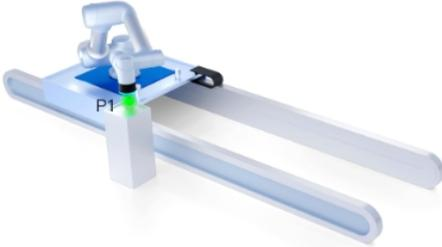
外部轴与机器人JOG(请将机器人末端与P1贴合并记录, P1为机器人与外部轴之外的固定一点)
