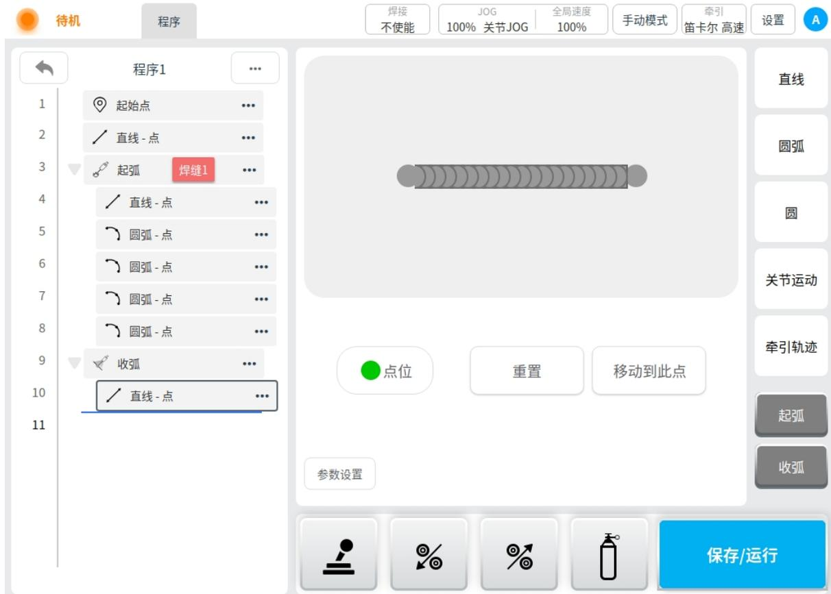
6. 到此一个简单的单道焊接程序就配置完成。但是在自动模式下，焊接程序执行完毕后会自动回到起始点重复执行当前程序；简单场景下，收弧下安全点即可保证焊枪安全回到起始点。在复杂场景下，需保证机器人姿态和运动轨迹处在安全位特别是多层多道焊接场景下。因此在收弧节点中提供过度轨迹，方便机器人安全回到起始点进行下一轮焊接。如下可添加各种运动轨迹：
