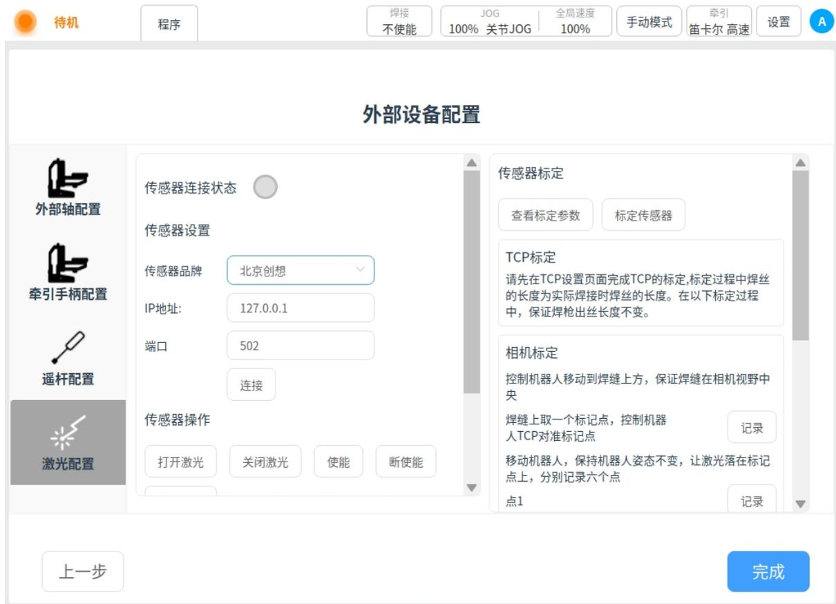
3、保持机器人姿态不变，打开激光，开启使能，移动机器人，让激光落在标记点上，在标记过程中观察激光软件上的激光图像，依次使激光图像分别为下图的六种状态，记录点位 1-6
