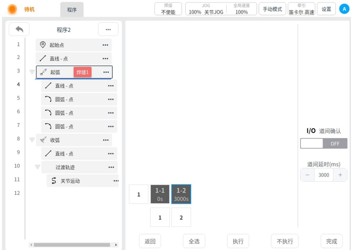
**任意焊道执行：**选中需要执行的焊道，并切换为可执行状态，点击右下方完成按钮进行保存即可；返回程序执行页面执行该程序，运行焊道即为所设置的焊道。例如：仅执行第二层的所有焊道
