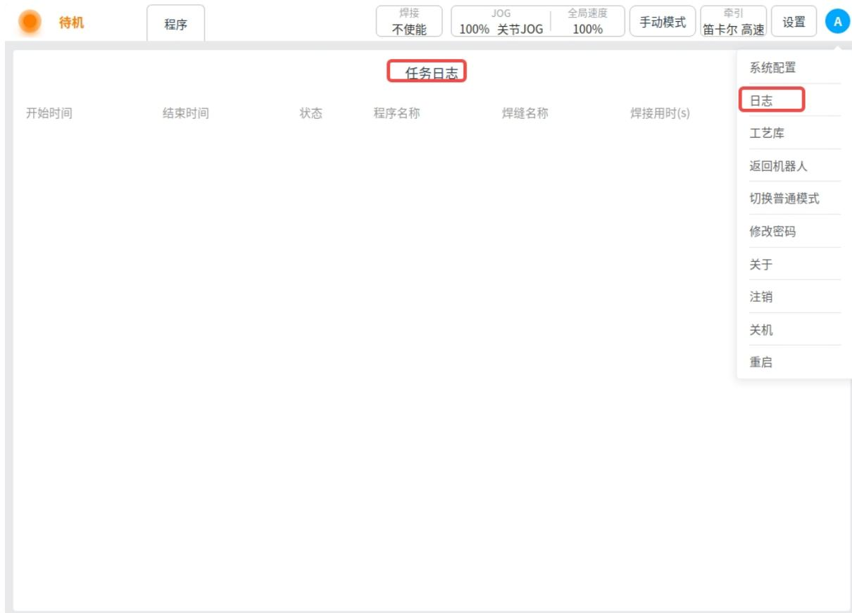
任务日志页面主要显示每次执行一次焊接任务会记录一条焊接信息，包括开始时间、结束时间、状态、工件名称、焊缝名称、焊缝用时以及焊缝长度。
