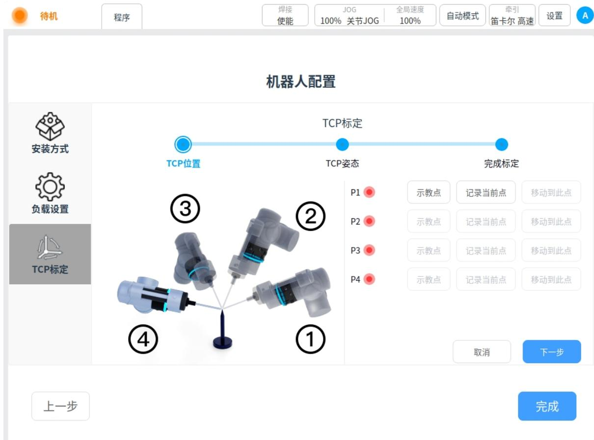
首先，需要以不同姿态将工具点贴合至标定针固定点，即示教好 P1-P4 点，且建议点与点之间的姿态角度变化在 45° 至 90° 之间，这样有利于提高 TCP 标定精度。以 P1 点为例，单击 P1 点处的“示教”按钮，界面会跳转到“机器人控制”页面，如下图所示。
