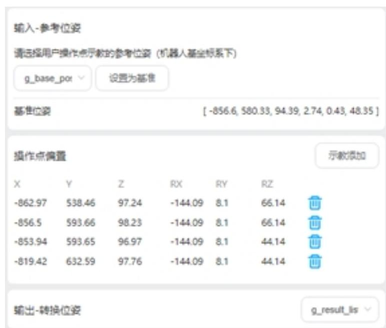
4、在操作点偏置中，示教添加作业点位，在输出中选择一个 pose\_list 类型变量存放计算得到的作业点位结果
