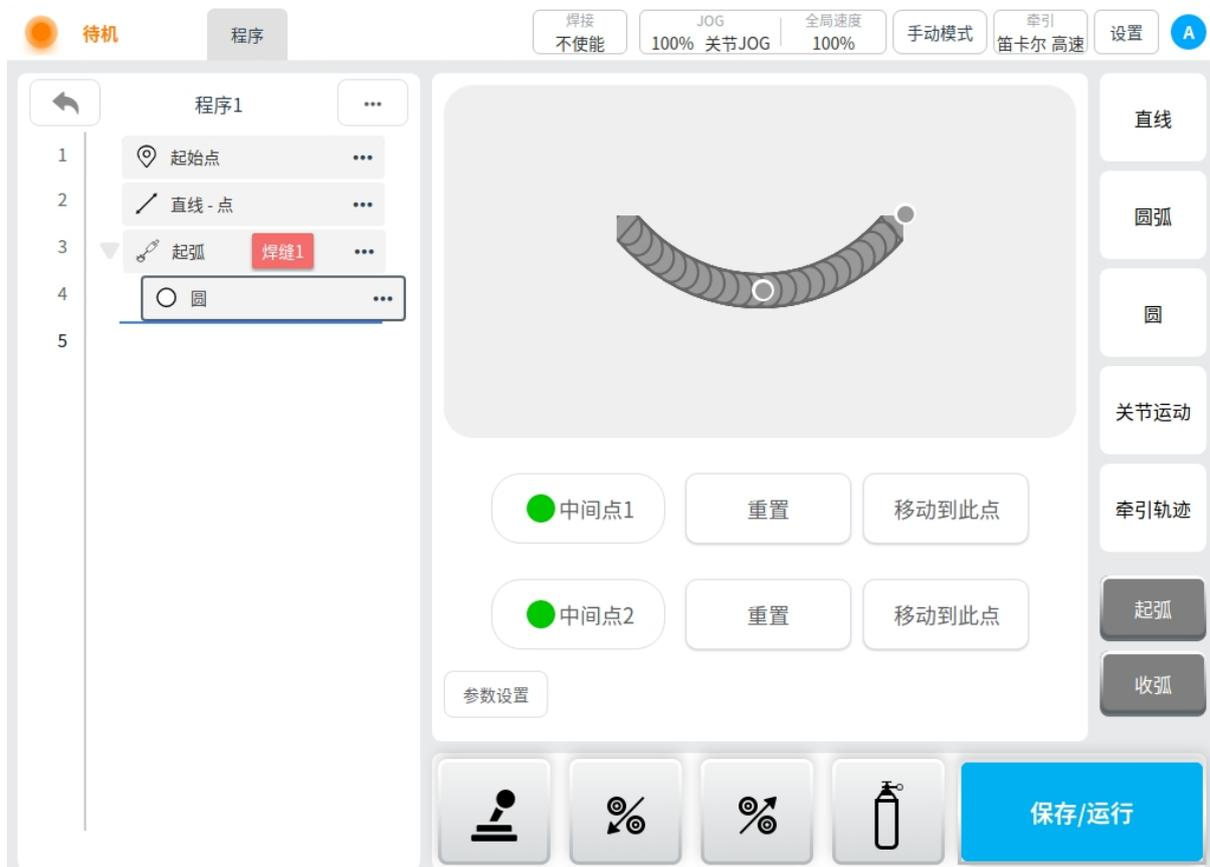
5. 在起弧下方配置焊缝执行类型以及轨迹后，需增加收弧节点，并且在收弧节点下需配置收弧的安全点，使机器人和焊枪回到安全位置；
