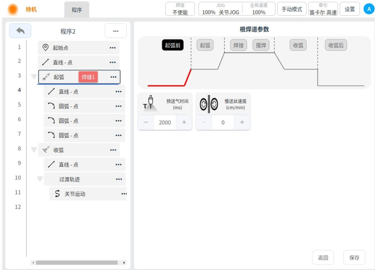
示例：第二层一道；非跟焊道需配置层间信息。配置层间信息如下图，配置完成后点击工艺参数再进行工艺参数配置（参照上方根示例）
