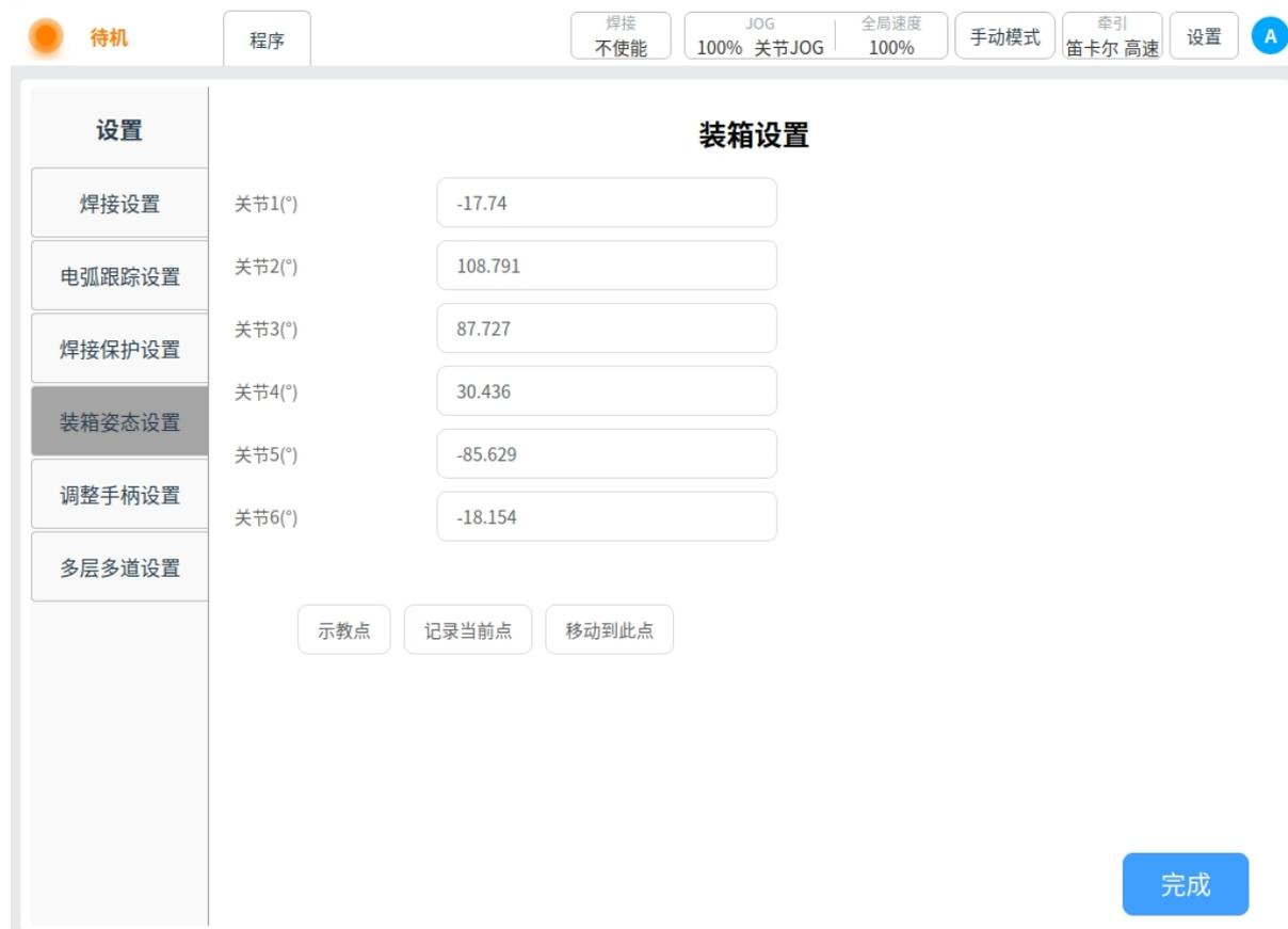
装箱设置，用户可通过单击装箱设置各个关节输入框，手动输入关节角度，也可通过单击“示教点”按钮，跳转到机器人控制界面进行示教设置，JOG 机器人到目标点后，单击“记录当前点”，界面会跳回当前子界面，页面显示示教好后的关节角度值，如下图所示。也可通过示教器物理按钮直接 JOG 机器人到目标点位后，直接单击页面“记录当前点”。若机器人不在装箱位置，长按“移动到此点”按钮，可以让机器人运动到打包装箱位置。
