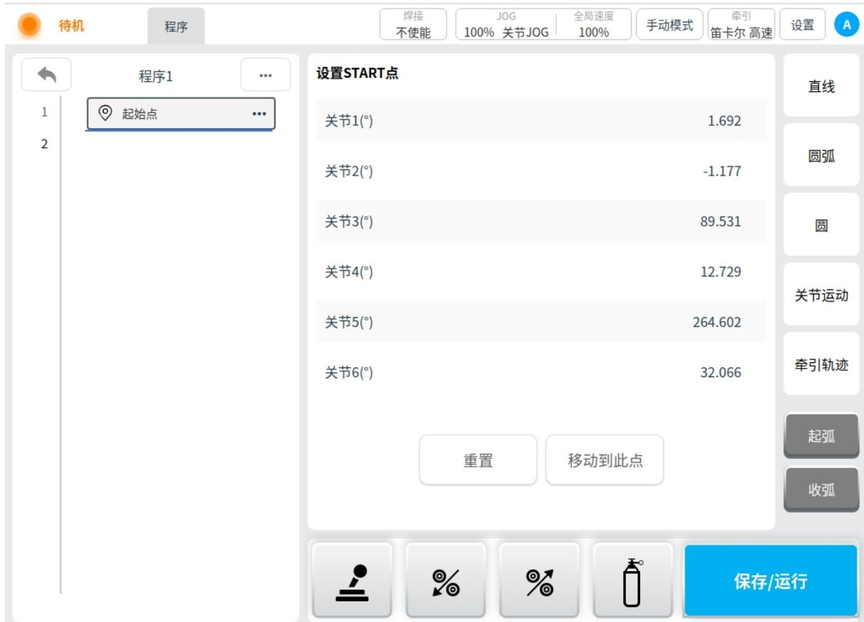
2. 点击页面右侧直线按钮，增加 **直线-点** 示教机器人使焊枪移动到起弧点，并记录当前点位置；
