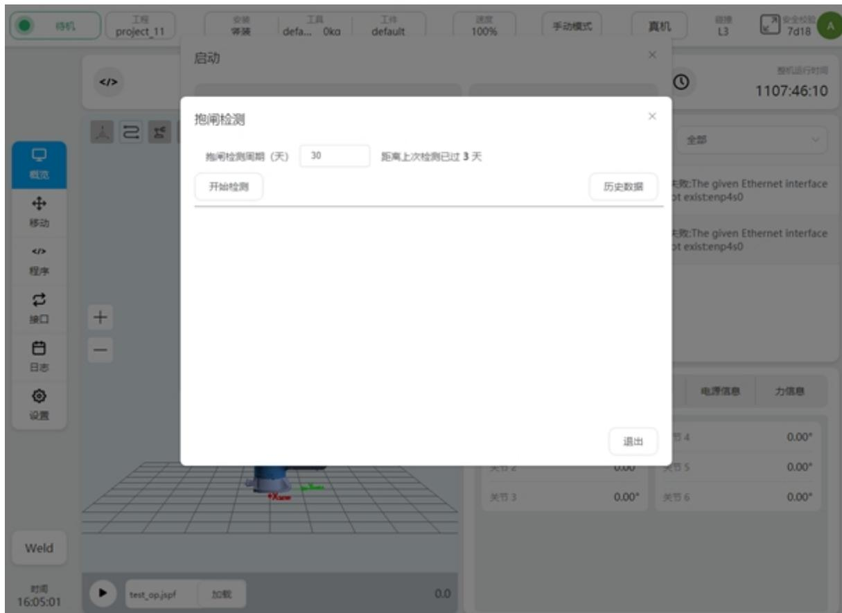
点击“开始检测”，弹出如下对话框，按照对话框提示进行操作。在检测的过程中可以暂停、停止检测过程。检测完成后，显示本次抱闸检测的结果。
