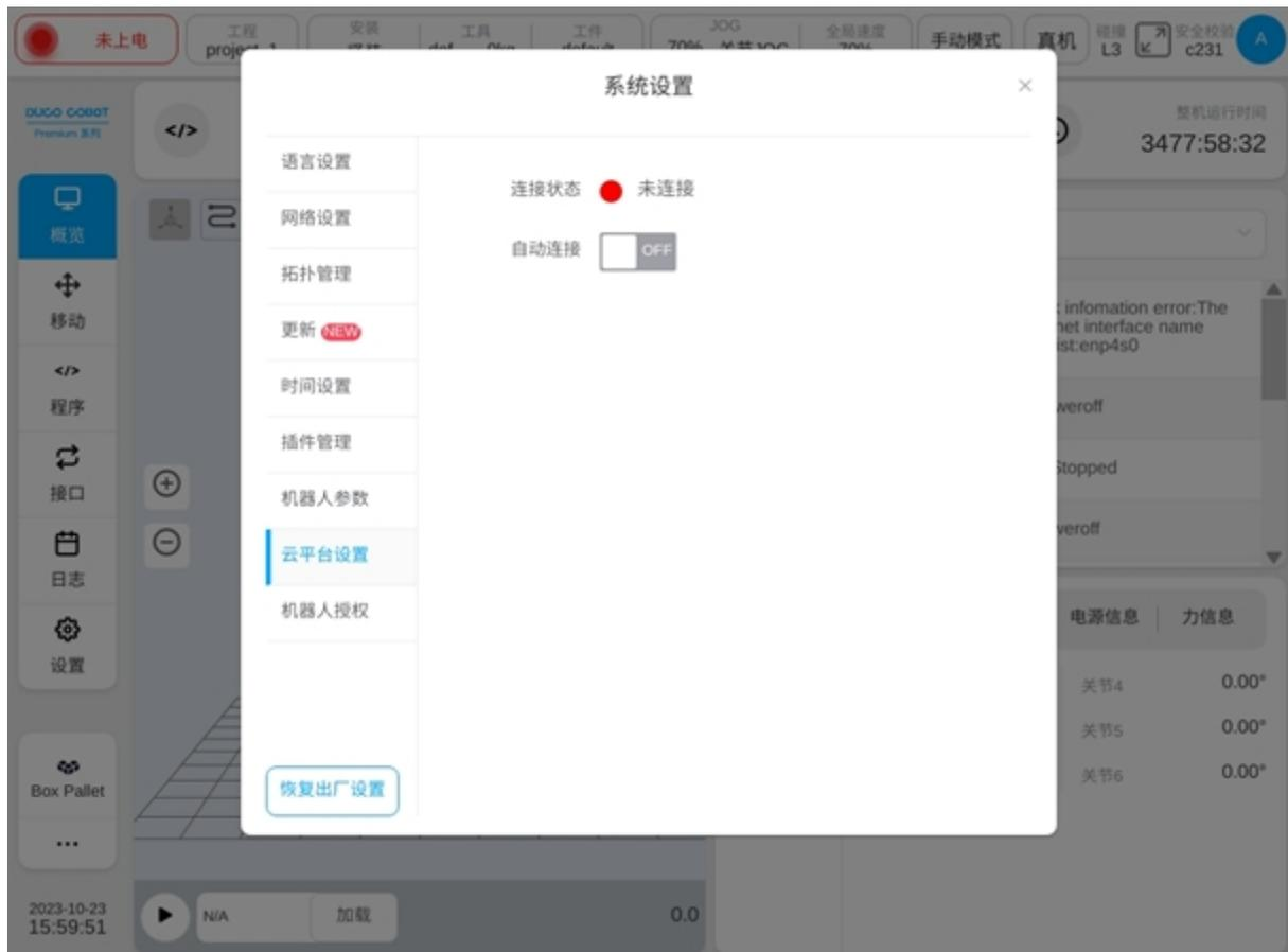
当用户手动输入云平台服务器 IP 地址后，切换“是否连接”开关，即可主动连接或断开与云端服务器的连接，且连接状态会对应改变。
