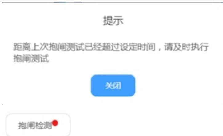
在机械臂使能的情况下，启动页面会出现抱闸检测功能的入口。点击可进入抱闸检测页面，如图。该页面可显示抱闸检测周期和距离上次抱闸检测过去的天数。
