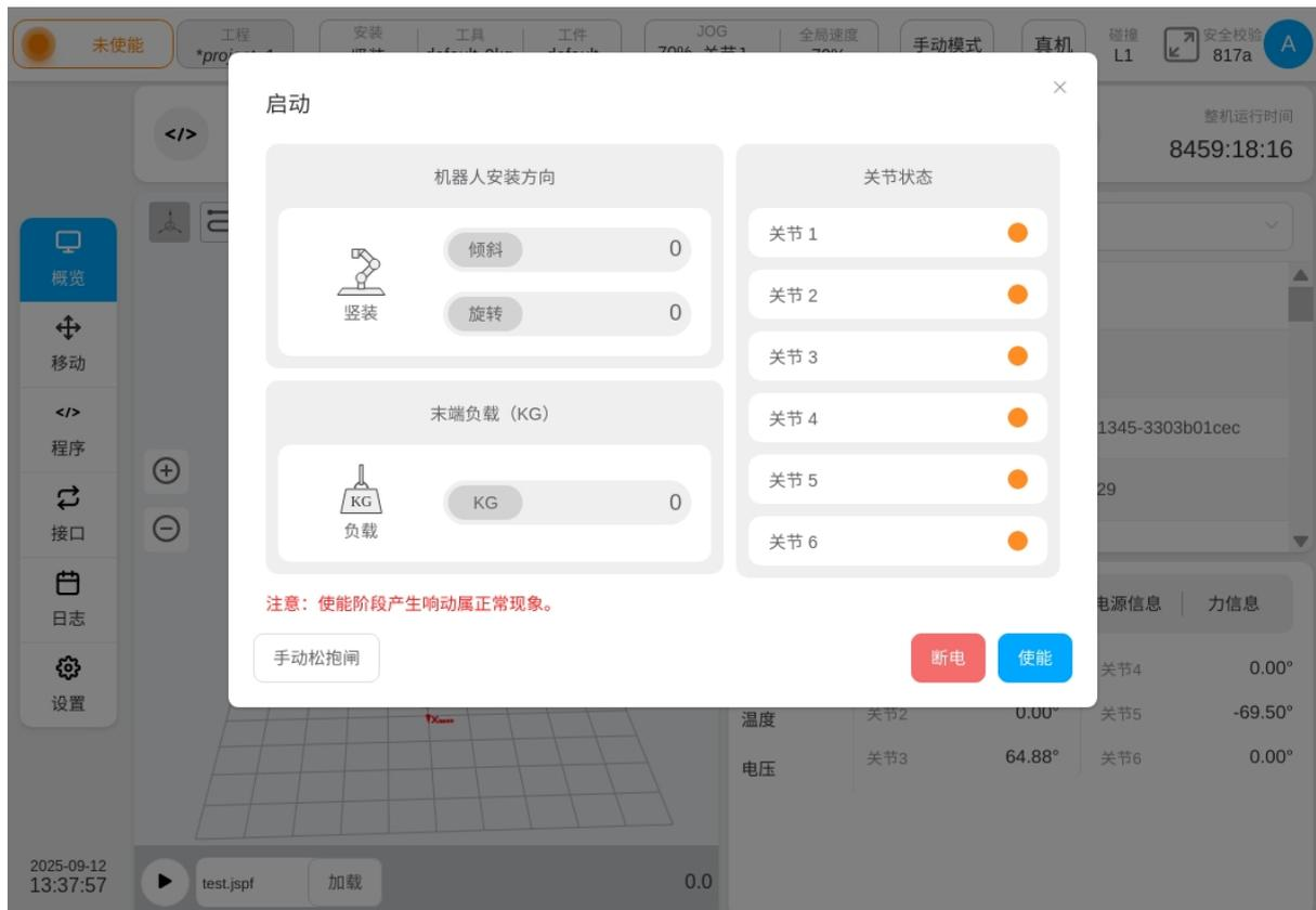
点击“断电”按钮，机器人会断开动力电并回到未上电状态。点击“使能”按钮，机器人会对所有关节进行使能，使能过程中各关节可能会产生微小的移动。
