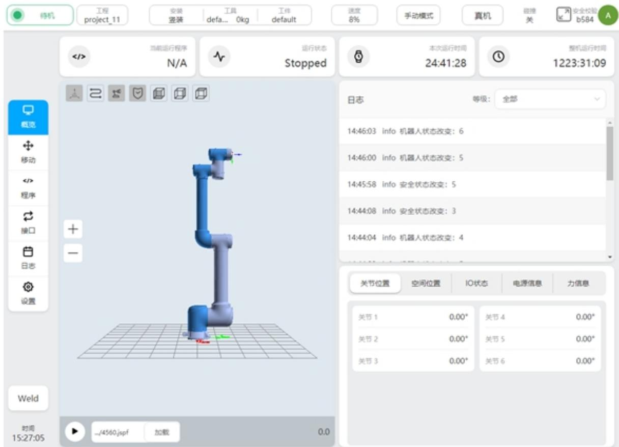
移动界面允许用户手动操作机器人，设置手动移动的坐标系及运动方式。
