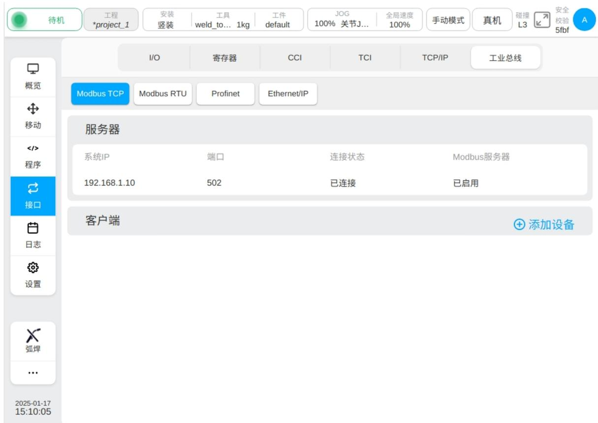
使用 Modbus TCP 功能，机器人可以作为 Modbus 客户端连接外部 Modbus 服务器设备，并读写 Modbus 服务器设备所提供的 Modbus 寄存器地址中所对应的数据内容。
