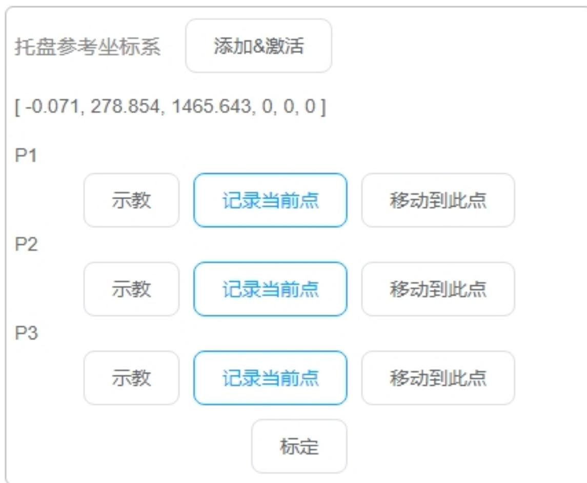
点击“添加 & 激活”按钮，将弹出对话框，输入该坐标系的名称后，将添加到系统中，并设为当前坐标系。
