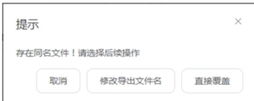
点击程序列表页上方“导出”按钮，会将当前目录下的所有文件与文件夹打包到一个压缩包中，压缩包名称为“当前程序列表名.program”并导出到外部设备的指定路径下。该压缩包不包含本级文件夹。与导出程序类似，存在同名文件时，同样会弹同名操作提示框。
