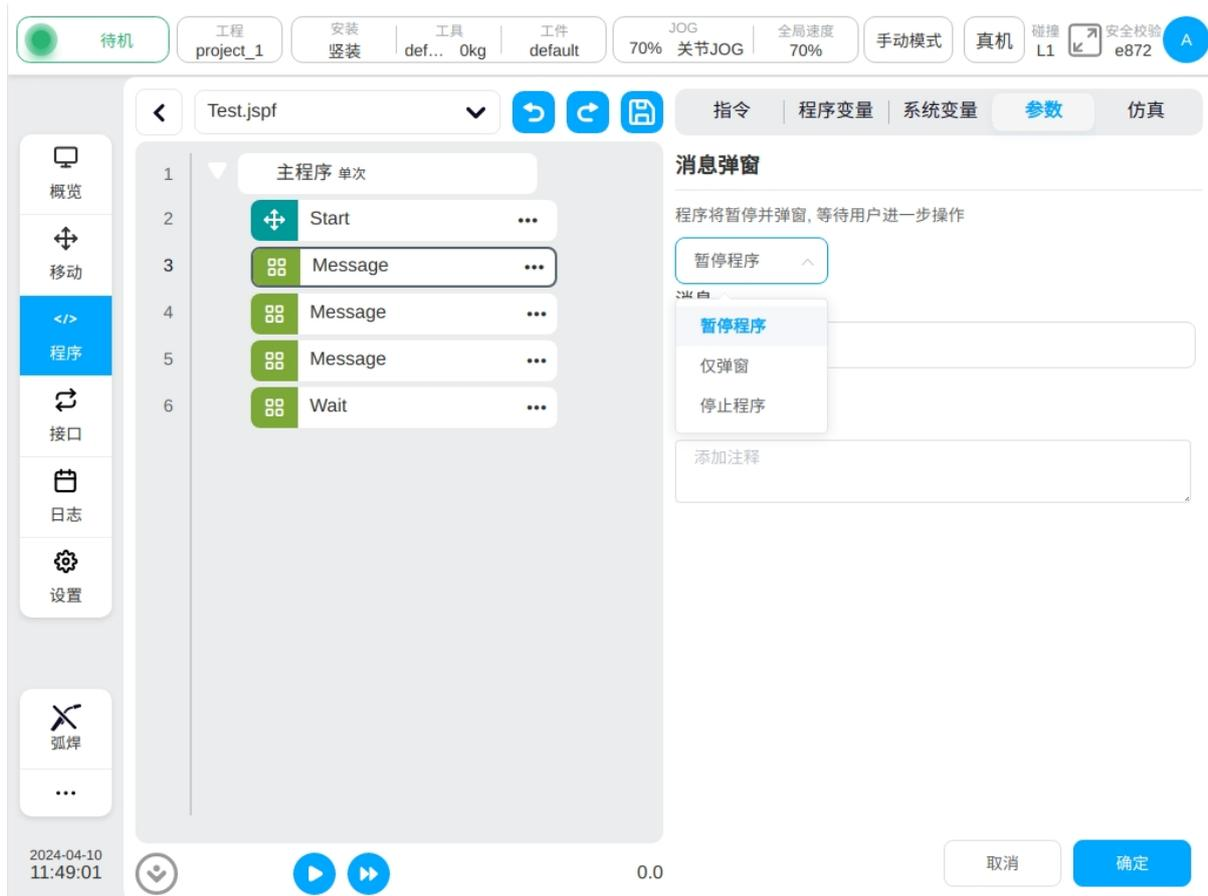
当选择暂停程序时，设定一条消息，程序运行到此功能块时可弹出一个对话框显示该消息并且程序暂停运行，用户可选择继续运行、停止程序或者关闭弹窗。
