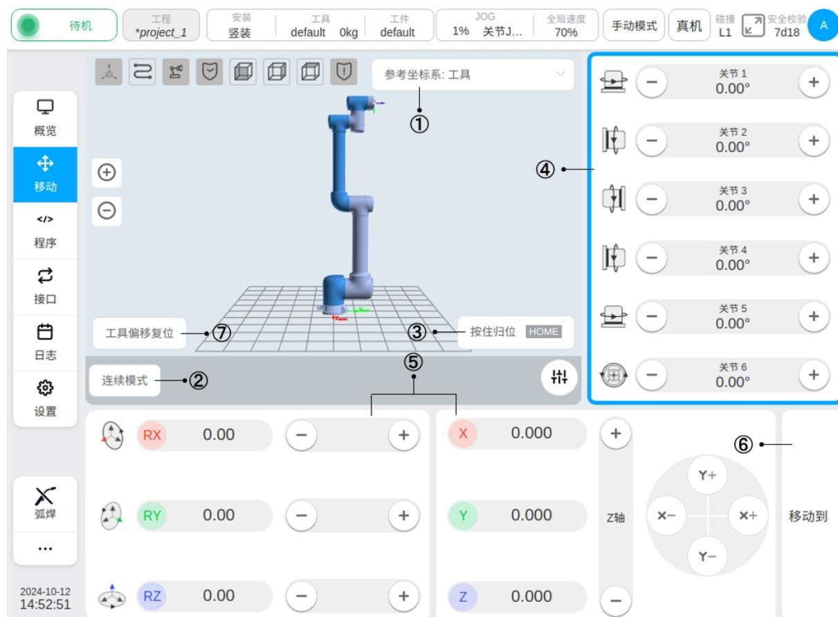
页面左上方显示 3D 仿真模型，单击图标 ① 选择器，可选择当前机器人使用的坐标系和手动操作机器人的参考坐标系，默认会使用世界坐标系（此系统中同基座坐标系），表示以机器人底座为坐标基点。还可选择工具坐标系和工件坐标系，工具坐标系表示以末端工具的末端点为坐标基点，工件坐标系由用户自由设定。切换参考坐标系后，界面上显示的机器人笛卡尔坐标下的位置姿态数据会相应改变。
