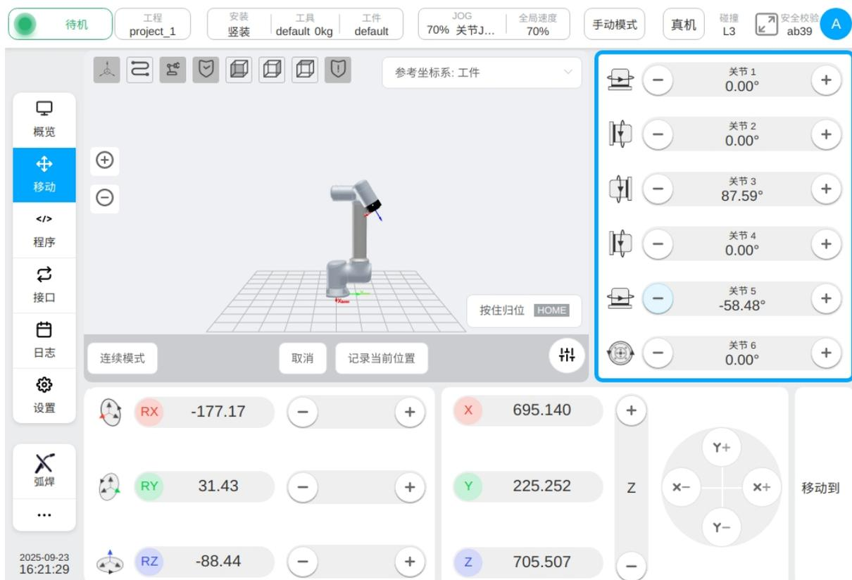
除了示教初始化外，用户也可单击初始值输入框，进行手动初始化赋值。joints 类型变量创建过程与 pose 类型类似，此处不累述。
