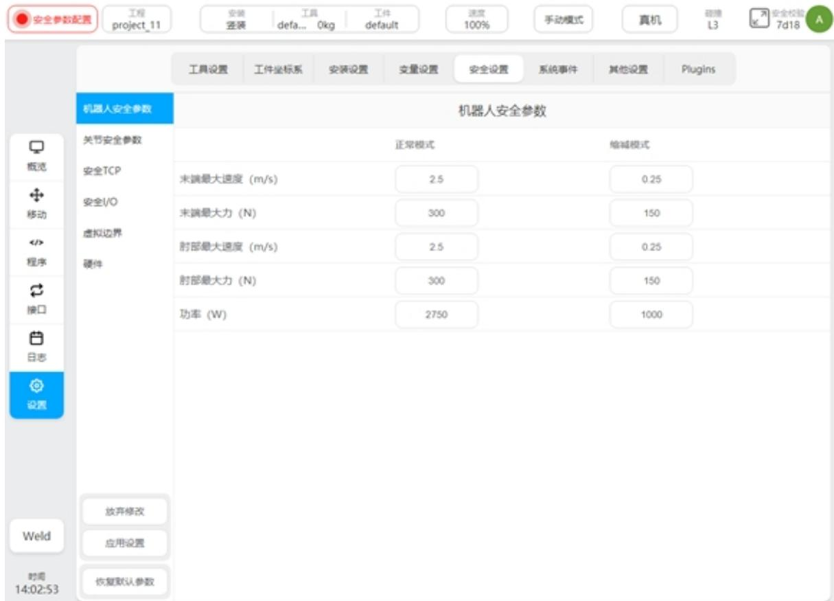
更改配置时，本次的修改内容将标记为高亮黄色显示出来。所做的所有更改只有在点击“应用设置”按钮时才会生效。点击“恢复默认设置”，将会将所有的安全参数恢复到默认的出厂设置值。点击“应用设置”按钮后，会弹出提示框，如图所示。
