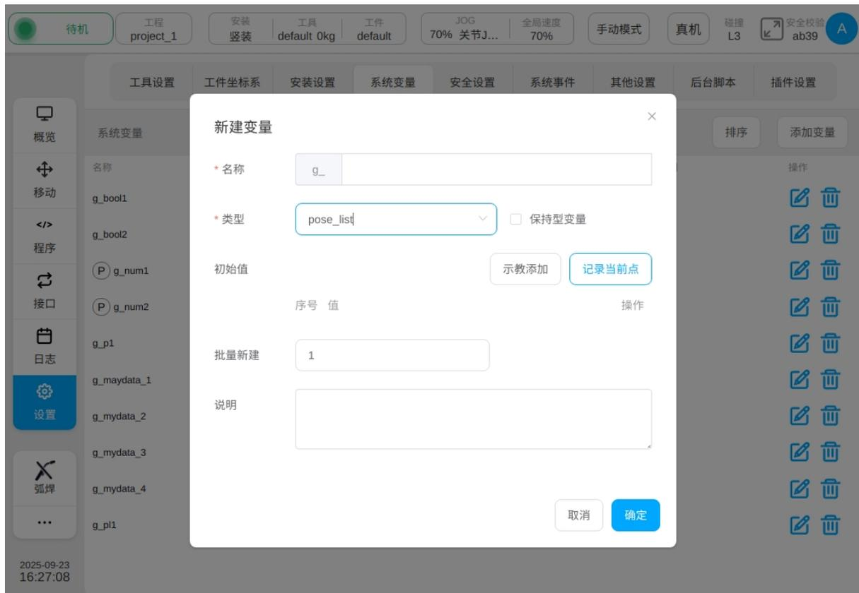
新建 pose\_list 类型变量时，初始值可以通过“示教添加”或“记录当前点”任意方式进行添加，点击“记录当前点”按钮，会在界面下方显示对应变量序号、值、操作，点击操作列的
