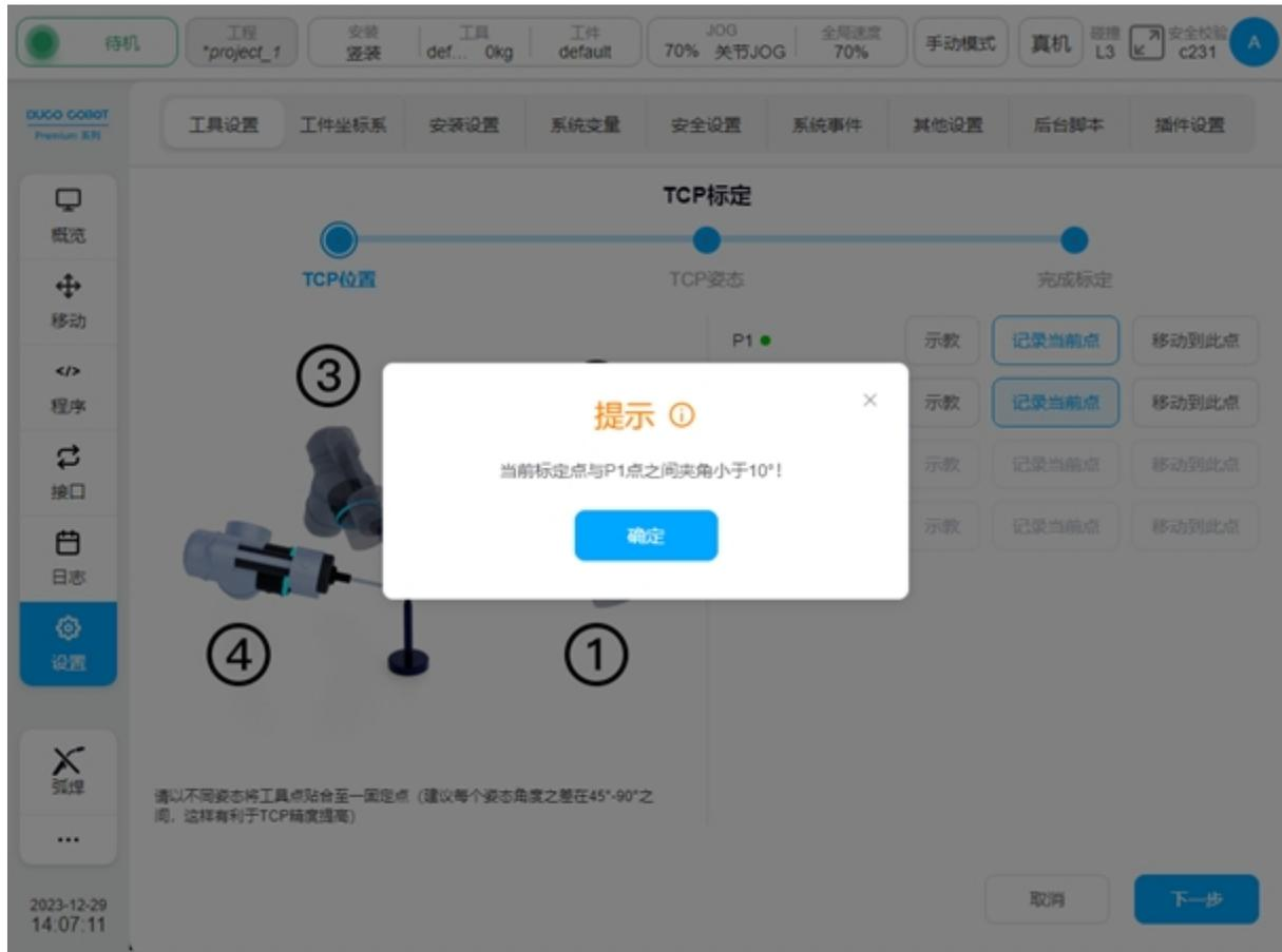
依次示教好 P1-P4 全部点位后，单击页面右下角“下一步”按钮，进入 TCP 姿态标定阶段。TCP 姿态标定有两种形式：自定义和两点设置，默认为自定义，如下图：
