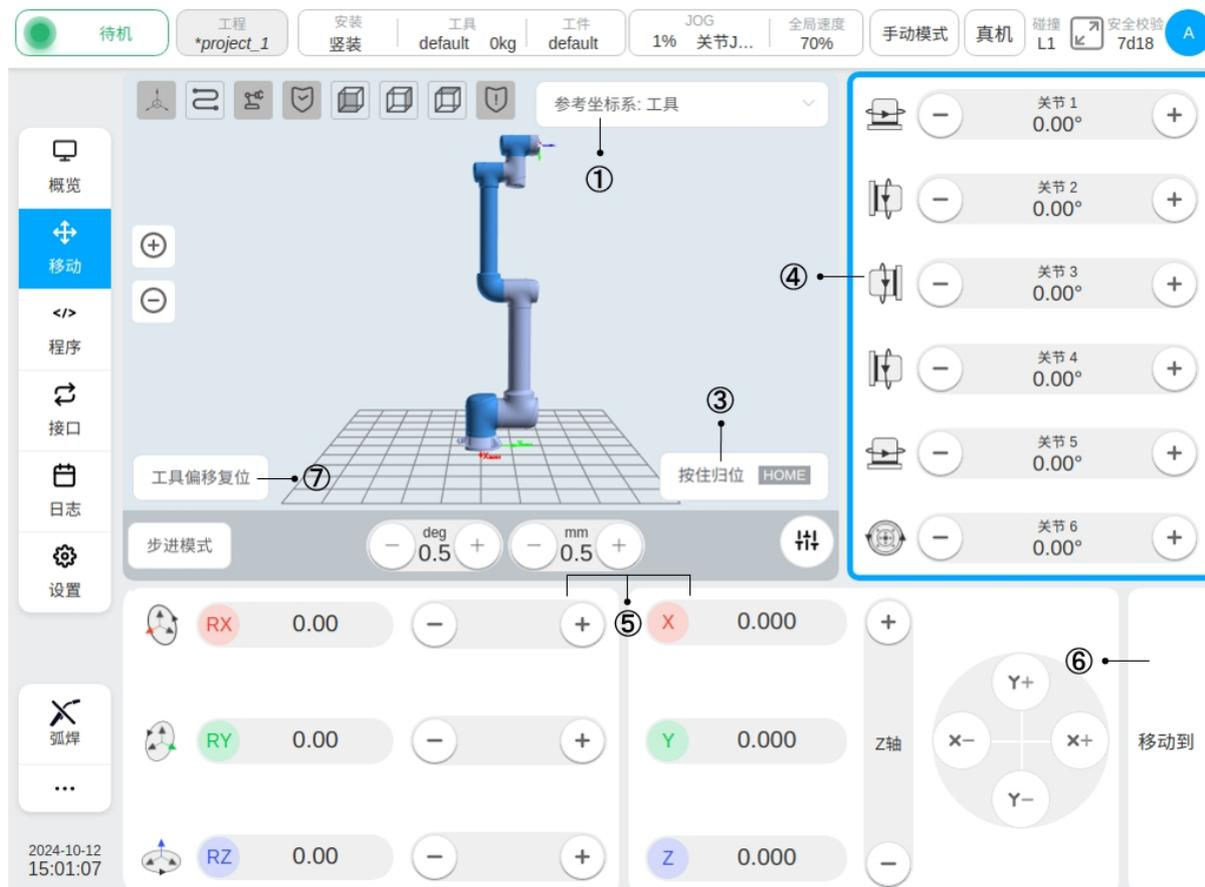
区域 ④ 是手动操作机器人关节移动的区域，当单击该区域任意地方，区域会显示蓝色边框，代表当前手动操作机器人关节移动。按住某个关节的左边箭头或右边箭头按钮可移动该关节向正方向或反方向移动，松开按钮机器人关节会停止移动。用户也可以通过按住示教器上右侧“+”“-”按钮移动关节，按钮从上到下分别对应关节 1~6。
