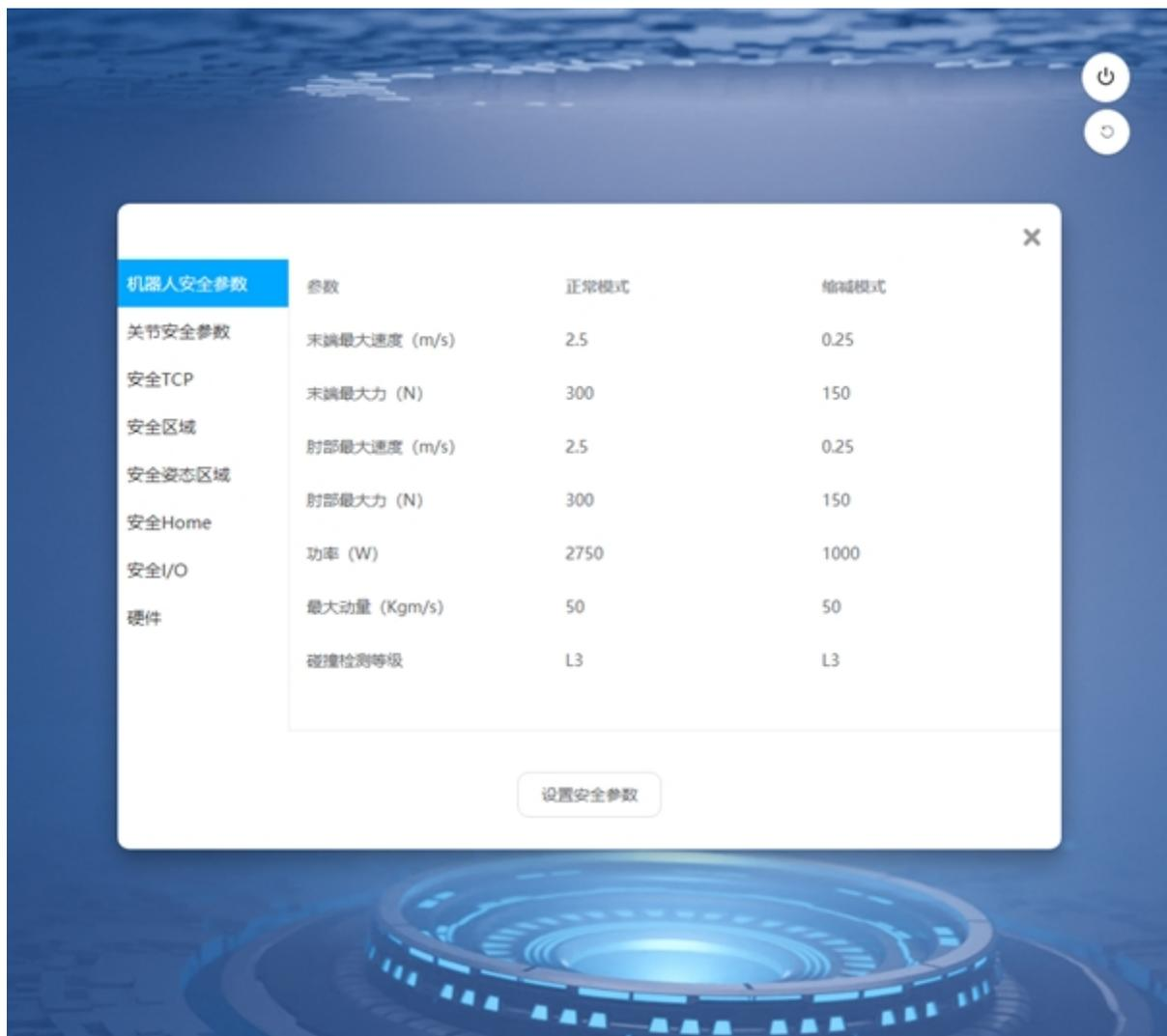
5. 确认安全参数正常后，点击“设置安全参数”，设置安全参数完成后，机器人初始化完成，根据提示重启控制柜。
