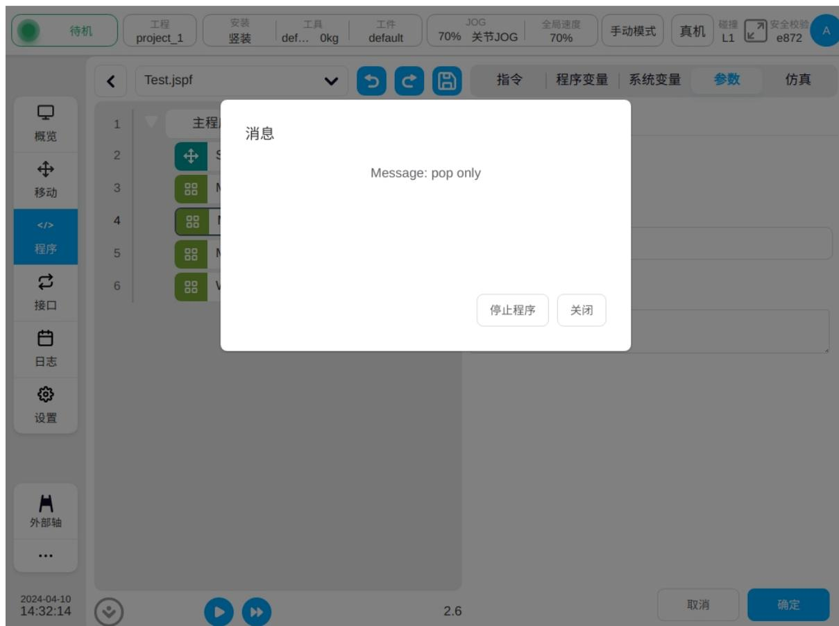
当选择停止程序时，设定一条消息，程序运行到此功能块时弹出一个对话框显示该消息并且程序直接停止运行，用户可选择关闭弹窗。
