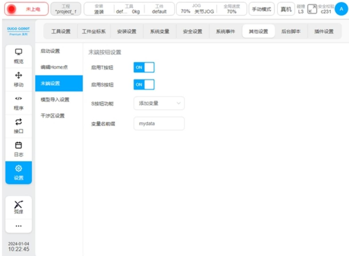
在启用 S 按钮前提下，当配置 S 按钮功能为添加变量时，变量名前缀使用默认值 mydata。单击触发 S 按钮，在变量设置页面会新添加一个 pose 类型的全局变量，如单次触发 3 次 S 按钮，变量设置页面会新增 3 个 pose 类型变量，变量名依次为 g\_mydata\_1、g\_mydata\_2、g\_mydata\_3，如图所示：
